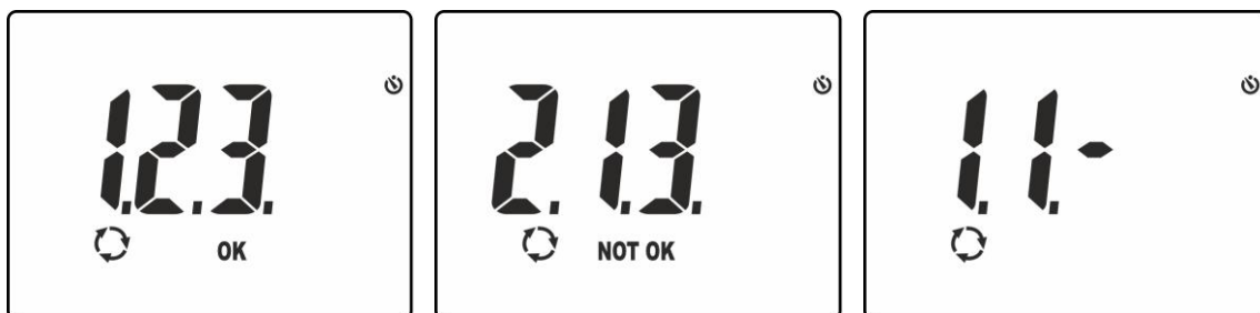
Fig. 16: Resultados de la prueba de secuencia y concordancia de las fases
