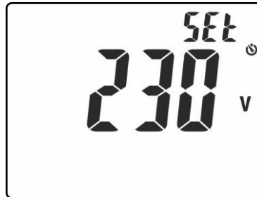
Fig. 6: Configuración tensión nominal en las medidas de Loop
