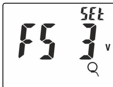
Fig. 7: Impostación fondo escala de pinza flexible
