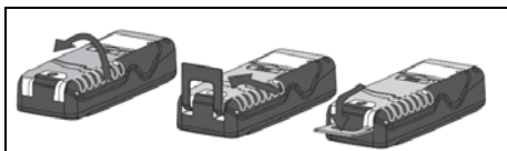
Fig. 4: Apertura del atril para medida sobre ángulos
