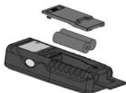
Fig. 14: Sustitución de las pilas internas
