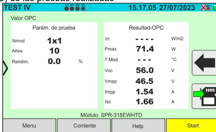
Fig. 54: Resultado medida curva I-V @OPC con registro síncrono
