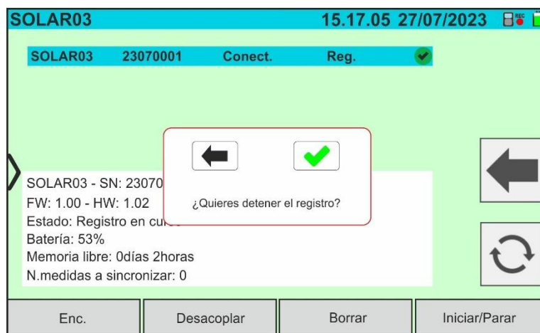
Fig. 55: Finalización de un registro en curso sobre la unidad remota
