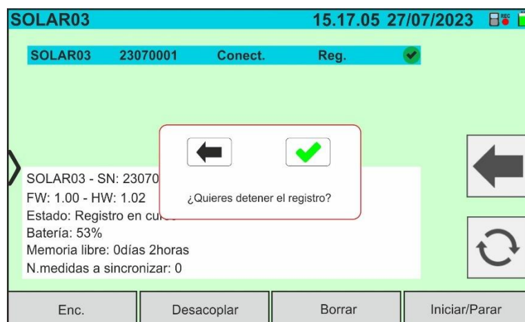
Fig. 77: Finalización registro en curso sobre la unidad remota
