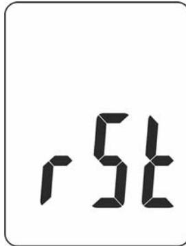
Fig. 5: Activación reset del instrumento
