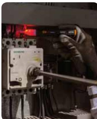
**Paso 2** - Ahora apoye el HT70 en la asumida fase L2 (sobre el conductor o sobre el aislante) durante al menos otros **5s** y espere a que el LED parpadee junto con el sonido del zumbador.
