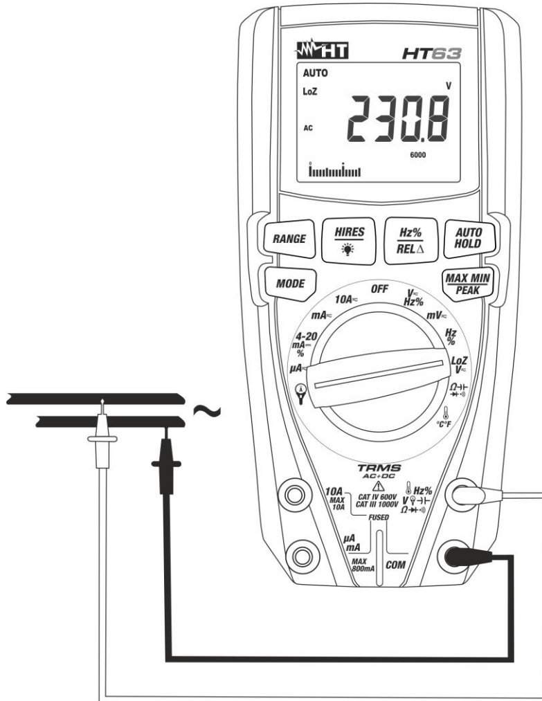
Fig. 4: Uso del instrumento para medida de Tensión CA, CC, CA+CC con función LoZ
