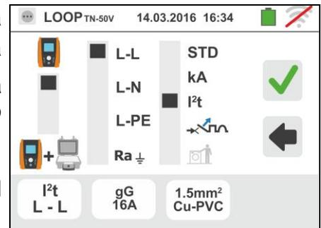
Desplace la referencia de la barra deslizante central seleccionando las opciones “L-L”, “L-N” o “L-PE”
