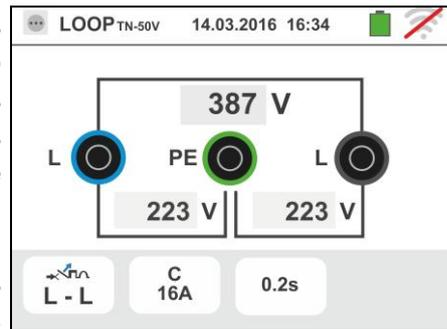
7. Pulse la tecla **GO/STOP** o bien la tecla **START** sobre la punta remota. Durante toda esta fase no desconecte los terminales de prueba del instrumento en la instalación en examen.
