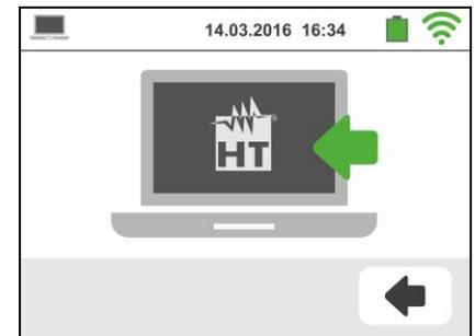
2. Habilite la conexión WiFi en el PC de destino (ej.: mediante el uso de una tarjeta WiFi instalada y conectada a un puerto USB) y conéctese a la red WiFi dispuesta por el instrumento (nombre de red "GSC60\_XXXXXX" en el cual XXXXXX es el número de serie del instrumento)
