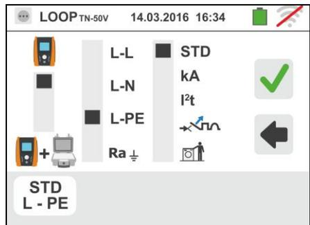
Desplace la referencia de la barra deslizante central seleccionando las opciones “L-L, L-N o L-PE”. Desplace la referencia de la barra deslizante derecha seleccionando la opción “STD”. Confirme la elección volviendo a la pantalla precedente
