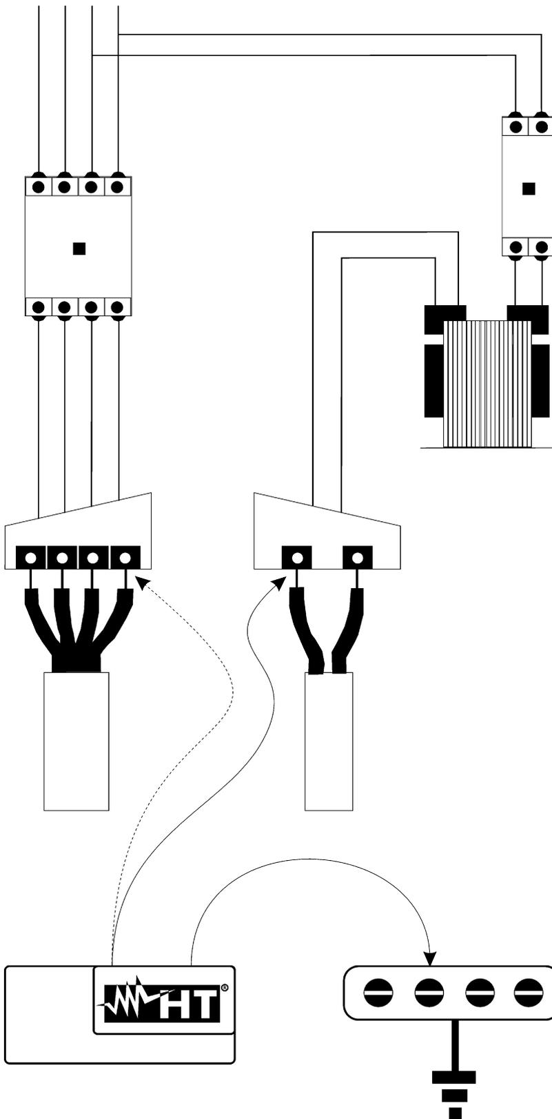
Transformador de aislamiento o de seguridad que efectúa la separación entre los circuitos
