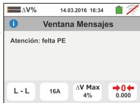
6. Si se detecta que los terminales de fase y neutro están intercambiados el instrumento no efectúa la prueba y muestra una pantalla como la de la derecha. Gira la toma shuko o controle el conexionado de los cables de medida
