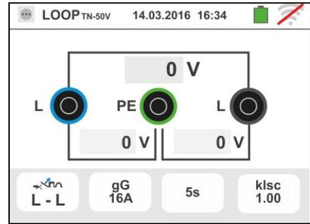
2. Desplace la referencia de la barra deslizante izquierda seleccionando el icono para la ejecución de la prueba con el instrumento o bien el icono para la ejecución de la prueba con instrumento + accesorio opcional IMP57 (vea § 6.4.10).
