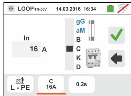
4. Toque el Icono
