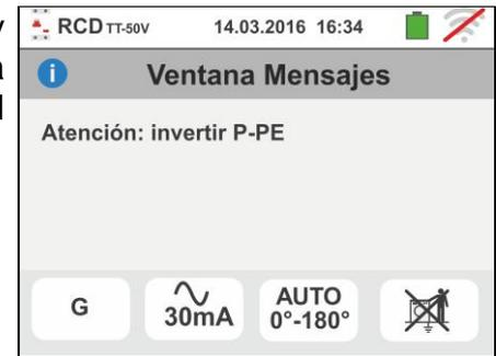
8. Si el interruptor diferencial en examen interviene durante la fase de pre-prueba (efectuado de forma automático del instrumento antes de efectuar la prueba seleccionada), el instrumento no realiza la prueba y muestra una pantalla como la de la derecha. Controle que el valor configurado de IdN sea coherente con el interruptor diferencial en examen y que todas las cargas conectadas aguas abajo del mismo estén desconectadas
