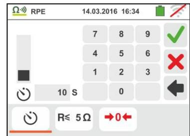
4. Toque el Icono “R≤xxΩ” para configurar el valor límite máximo de la resistencia sobre la cual el instrumento realiza la comparación con el valor medido. La pantalla de la derecha se muestra en el visualizador
