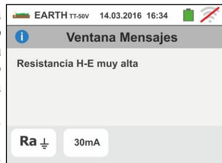
4. Al inicio de la medida el instrumento verifica la situación de las entradas B2 (S) y B3 (ES). En caso de inversión de los conductores sobre la instalación, se bloquea la prueba y muestra el mensaje siguiente
