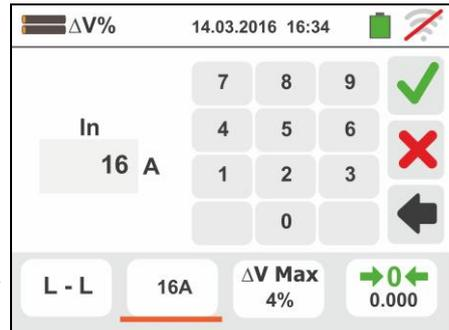
9. Toque el icono para poner a cero el valor en el campo “%” y utilice el teclado virtual para configurar el valor de la  $\Delta V\%$  comprendido entre **1%** y **99%**. Confirme la elección volviendo a la pantalla anterior
