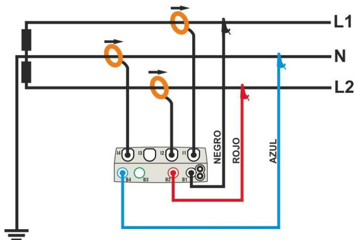
Fig. 44: Conexión para medida en sistema Bifásico  $1\phi$ -Toma Central – sistemas USA
