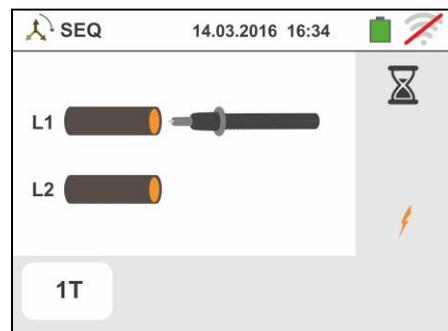
6. Al término de la obtención de la fase L1 el instrumento se pone en condición de espera la señal sobre la fase L2 mostrando el símbolo de la “punta desconectada” como se muestra en la pantalla de la derecha
