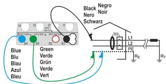
Fig. 11: Conexionado sistema bifásico sin neutro (no RCD tipo B)
