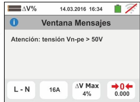
10 Si durante la medida se obtiene un valor de impedancia de final de línea inferior al de inicio de línea el instrumento no efectúa la prueba y muestra una pantalla como la siguiente. Controle el estado de la línea en examen
