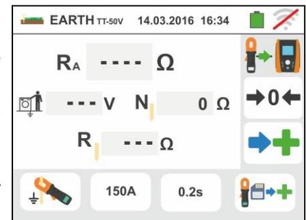
Medida de resistencia de los dispersores con pinza T2100 conectada al instrumento
