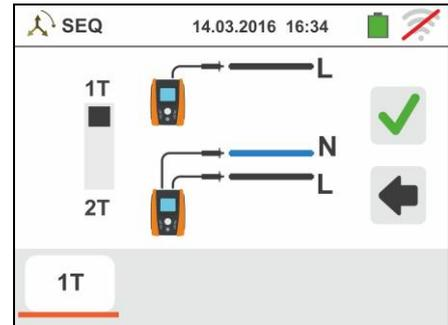
3. Inserte los conectores azul y negro de los cables en los correspondientes terminales de entrada del instrumento B4, B1 (prueba 2T). Inserte en el extremo de los cables que quede libre los correspondientes cocodrilos o puntas. Eventualmente utilice la punta remota insertando el conector multipolar en el terminal de entrada B1. Conecte los cocodrilos, puntas o la punta remota a la fase L1 y N de acuerdo con las Fig. 23 y Fig. 24
