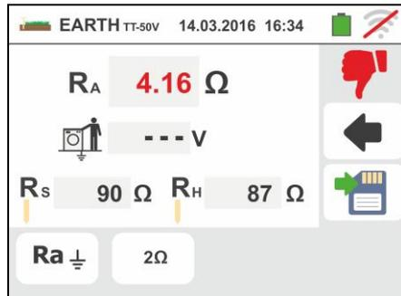
Note la presencia del resultado de la prueba marcado en rojo
