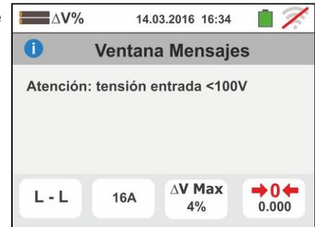
3. Si el instrumento obtiene la ausencia de la señal sobre el terminal B1 (conductor de fase) proporciona la pantalla de aviso mostrada a la derecha y bloquea el desarrollo de las pruebas
