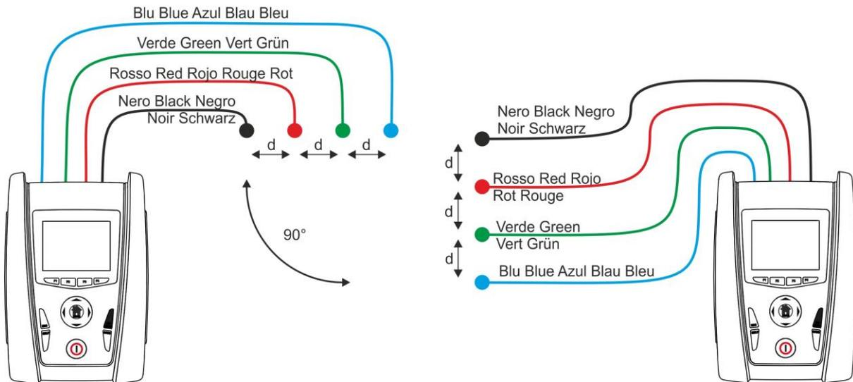
Fig. 55: Medida de la resistividad del terreno
