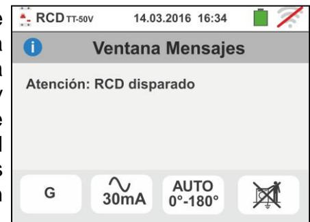
9. Si el instrumento detecta un potencial peligroso sobre el conductor PE, se bloquea la prueba y muestra el mensaje siguiente. Controle la eficiencia del conductor PE y de la instalación de tierra. Este mensaje se muestra también por una pulsación insuficiente de la tecla **GO/STOP**
