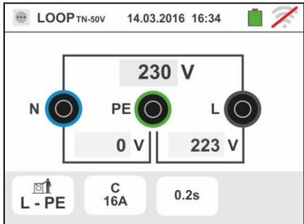
7. Pulse la tecla **GO/STOP** para 2s o bien la tecla **START** sobre la punta remota. Durante toda esta fase no desconecte los terminales de prueba del instrumento en la instalación en examen.
