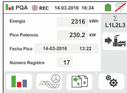
18 Toque el icono
