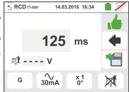
9. Al término de la prueba en el caso en el cual el tiempo de intervención medido NO sea dentro del intervalo: **[retardo límite = retardo configurado + valor indicado en la Tabla 5 (vea § 13.4)]**, el instrumento muestra el símbolo señalando el resultado negativo de la prueba y muestra una pantalla como la de la derecha
