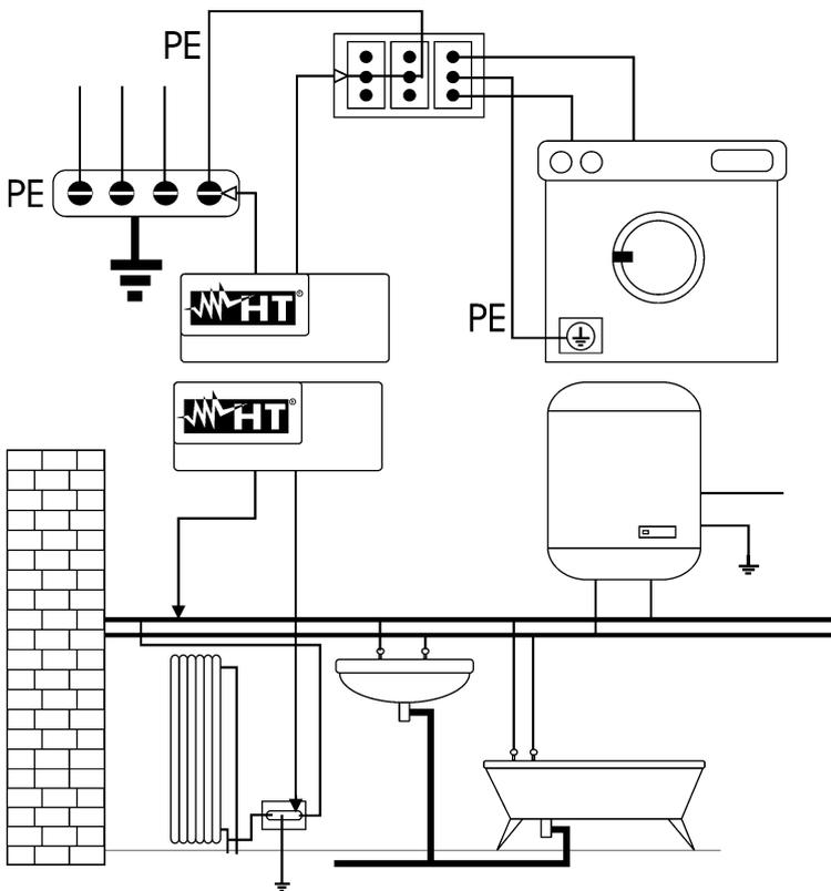
Conecte una de las puntas al conductor de protección de la toma de fuerza motriz y la otra al nodo equipotencial de la instalación de tierra.
