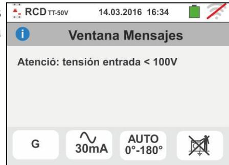
3. Si el instrumento detecta ausencia de señal sobre el terminal B1 (conductor de fase) muestra la pantalla de aviso de la derecha y se bloquea la prueba
