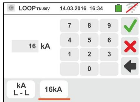
4. Desconecte, cuando sea posible, todas las cargas conectadas aguas abajo del punto de prueba en cuanto la impedancia de dichas cargas podría influenciar los resultados de la prueba. Conecte la toma shuko, los cocodrilos o la punta remota a la red eléctrica de acuerdo con las Fig. 17, Fig. 18, Fig. 19 y Fig. 21 en el punto más cercano de las protecciones
