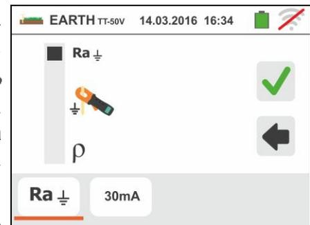
3. Desplace la referencia de la barra deslizante en la posición correspondiente al valor de la corriente de intervención del diferencial RCD como se muestra en la pantalla de la derecha. Sobre la base de esta selección y del valor de la tensión de contacto (25V o 50V) el instrumento realiza el cálculo del valor límite de la resistencia de tierra (vea § 13.7) que comparará con el valor medido a fin de proporcionar el resultado final positivo o negativo de la medida
