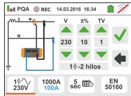
3. Desplace la barra deslizante para seleccionar las opciones relativas a la elección del tipo de pinza para la medida de las corrientes de fase y de la corriente de neutro (marcada en color azul) considerando que las **pinzas pueden ser de distinto tipo** entre las opciones:
