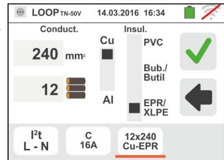
Desplace la referencia de la barra deslizante central seleccionando el tipo de conductor. Están disponibles las opciones **Cu** (Cobre) y **Al** (Aluminio)
