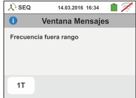
3. Si se obtuviera una frecuencia de la tensión en entrada fuera del rango permitido, el instrumento muestra una pantalla como la de la derecha.
