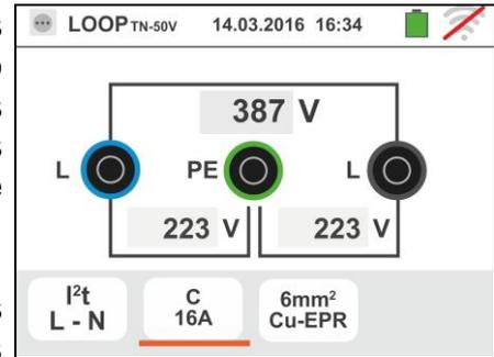
7. Pulse la tecla **GO/STOP** para 2s o bien la tecla **START** sobre la punta remota. Durante toda esta fase no desconecte los terminales de prueba del instrumento en la instalación en examen.
