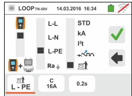
3. Desplace la referencia de la barra deslizante seleccionando el tipo de protección (Fusible de tipo **gG** o **aM** o magnetotérmico MCB en curva **B, C, K, D**)
