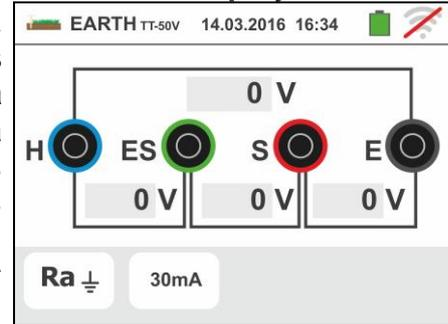
2. Desplace la referencia de la barra deslizante en la posición “**Ra** para la selección de la prueba de tierra con método voltiamperimétrico, en la posición para la prueba de resistencia con uso de pinza opcional T2100 (vea § 6.7.3) o en la posición “ $\rho$ ” para la prueba de resistividad del terreno. Confirme la elección volviendo a la pantalla inicial de la medida.
