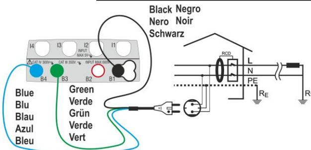
Fig. 10: Conexionado en sistema monofásico mediante la toma shuko
