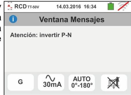
7. Si se detecta el cambio entre los terminales de fase y PE el instrumento no efectúa la prueba y muestra una pantalla como la de la derecha. Controle el conexionado de los cables de medida
