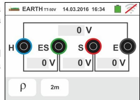
Toque el Icono de la derecha para configurar la unidad de prueba y la distancia entre las sondas de prueba. La siguiente pantalla se muestra en el visualizador
