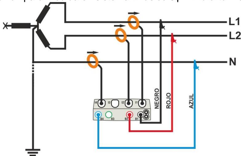
Fig. 43: Conexión para medida en sistema Bifásico  $3\phi$ -2EI.  $\frac{1}{2}$  – sistemas USA
