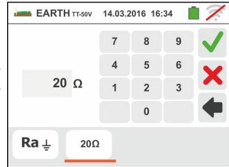
6. Pulse la tecla **GO/STOP**. Durante toda esta fase no desconecte los terminales de prueba del instrumento en la instalación en examen. El símbolo
