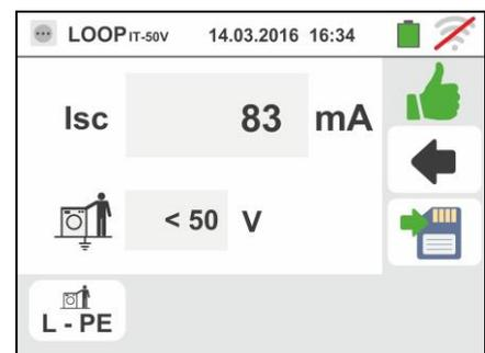
5. En caso de resultado negativo (tensión de contacto en el punto >50V o >25V) la pantalla de la derecha se muestra en el instrumento (vea § 13.8)
