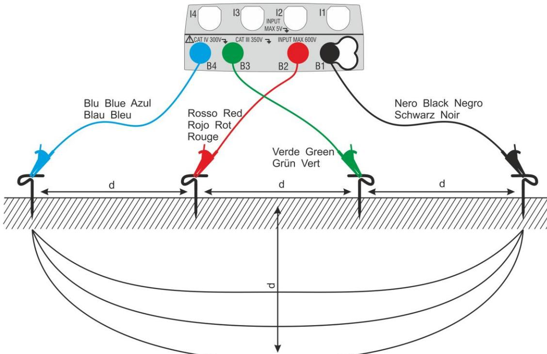
Fig. 30: Medida de la resistividad del terreno
