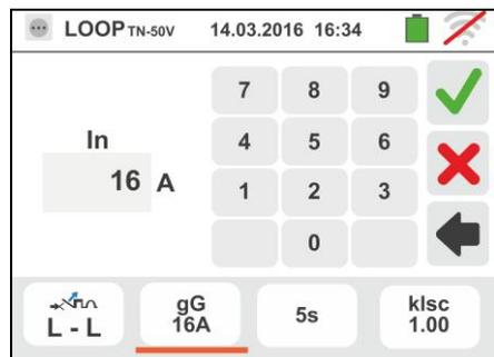
5. Desplace la referencia de la barra deslizante seleccionando el tiempo de intervención de la protección entre las opciones: **0.1s, 0.2s, 0.4s, 1s, 5s**
