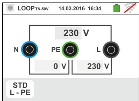
Pulse la tecla **GO/STOP** para 2s o bien la tecla **START** sobre la punta remota. Durante toda esta fase no desconecte los terminales de prueba del instrumento de la instalación en examen. La siguiente pantalla se muestra en el instrumento
