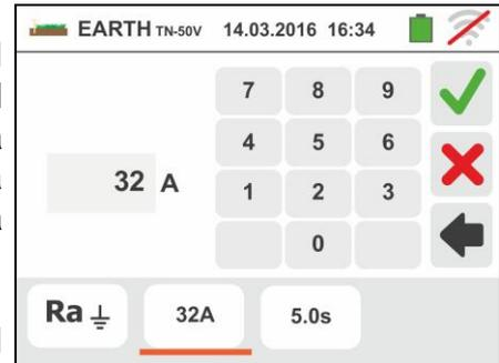
Toque el Icono inferior derecho para configurar el tiempo de intervención de la protección. La siguiente pantalla se muestra en el visualizador
