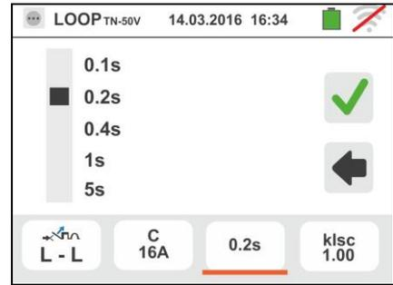
6. Toque el icono
