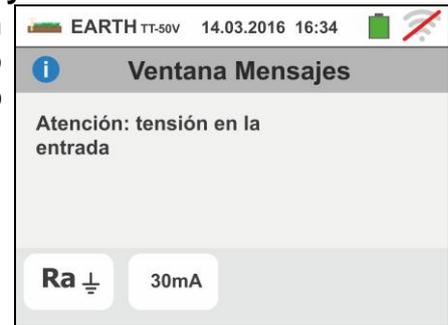
2. Al inicio de la medida el instrumento verifica la continuidad de los cables de medida. **Si el circuito voltimétrico (cables rojo S y verde ES) estuviera interrumpido o presente una resistencia demasiado elevada**, el instrumento muestra una pantalla similar a la de la derecha
