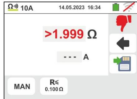
8. **En caso de medida AUTO**, el instrumento entra en modo de espera y muestra la pantalla al lado después de haber realizado una prueba.
