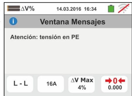
9. Si se obtuviera la presencia de una tensión VN-PE >50V (o bien > 25V en base a las selección) el instrumento no efectúa la prueba y muestra una pantalla como la siguiente
