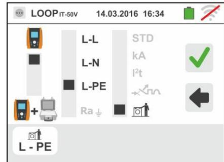
3. Desconecte, cuando sea posible, todas las cargas conectadas aguas abajo del punto de prueba en cuanto la impedancia de dichas cargas podría influenciar los resultados de la prueba. Conecte cocodrilos o la punta remota a la red eléctrica de acuerdo con la Fig. 22. Note la presencia de los valores de tensión correctos entre L-N y L-PE correspondientes a las selecciones hechas en fase inicial (vea § 5.1.4) y una eventual tensión N-PE por efecto del sistema IT como se muestra en la pantalla
