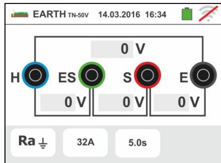
5. Toque el Icono para poner a cero el valor en el campo “A” y utilice el teclado virtual para configurar el valor de la corriente de defecto (declarada por la entidad de distribución de la energía) comprendida entre **1A** y **9999A**. Confirme la elección volviendo a la pantalla inicial de la medida
