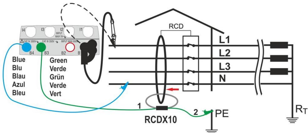
Fig. 16: Conexión a RCD con toroidal separado con accesorio opcional RCDX10
