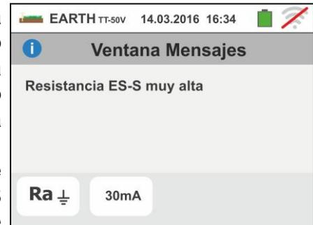
3. Al inicio de la medida el instrumento verifica la continuidad de los cables de medida. **Si el circuito amperimétrico (cables azul H y negro E) estuviera interrumpido o hubiera una resistencia demasiado elevada**, el instrumento muestra una pantalla similar a la de la derecha
