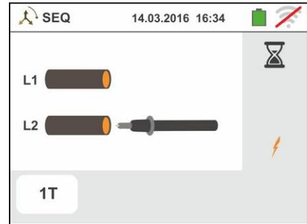
8. Al término de la prueba, en el caso en el cual el sentido cíclico obtenido resulte correcto, el instrumento muestra una pantalla como la de la derecha (resultado “1-2-3”)
