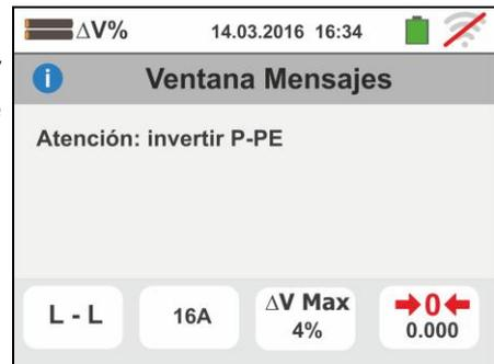
8. Si se obtuviera la presencia de una tensión peligrosa sobre el terminal PE el instrumento no efectúa la prueba y muestra una pantalla como la siguiente. Este mensaje se muestra también por una pulsación insuficiente de la tecla **GO/STOP**
