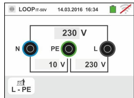
4. Pulse la tecla **GO/STOP** para 2s o bien la tecla **START** sobre la punta remota. Durante toda esta fase no desconecte los terminales de prueba del instrumento en la instalación en examen.
