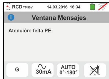
6. Si se detecta el cambio entre los terminales de fase y neutro el instrumento no efectúa la prueba y muestra una pantalla como la de la derecha. Invierta la toma shuko o controle el conexionado de los cables de medida
