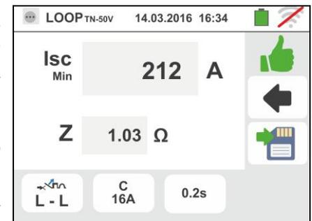
8. En caso de resultado negativo (corriente de cortocircuito mínima no interrumpida del dispositivo de protección en el tiempo indicado por las selecciones realizadas) la pantalla de la derecha se muestra en el instrumento
