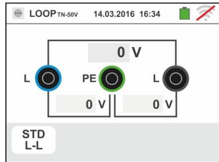
2. Desplace la referencia de la barra deslizante izquierda seleccionando el Icono para la ejecución de la prueba con el accesorio IMP57
