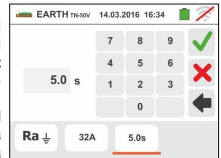
Sobre la base de las precedentes selecciones el instrumento realiza el cálculo del límite máximo de la resistencia de tierra en función del valor de la máxima tensión de contacto admitida (vea § 13.12) que comparará con el valor medido a fin de proporcionar el resultado final positivo o negativo de la medida
