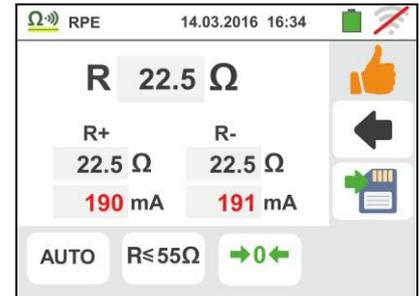
2. Si de forma  $\rightarrow 0 \leftarrow$  el instrumento obtuviera en los mismos terminales una resistencia superior a  $2\Omega$  pone a cero el valor compensado y muestra una pantalla como la de la derecha. El Icono  $\rightarrow 0 \leftarrow$  se muestra en el visualizador indicando el valor puesto a cero de la calibración (ejemplo: realizando la operación con terminales abiertos)
