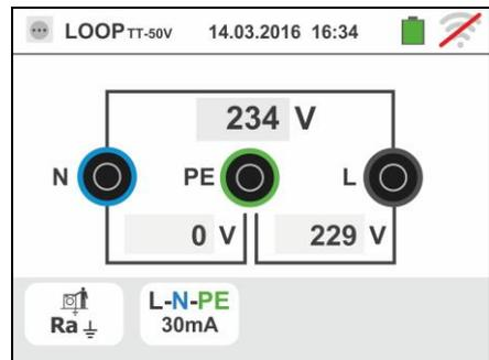
5. Pulse la tecla **GO/STOP** para 2s o bien la tecla **START** sobre la punta remota. Durante toda esta fase no desconecte los terminales de prueba del instrumento en la instalación en examen.
