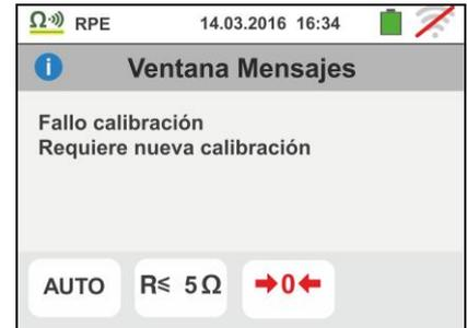
3. Si se obtuviera que la resistencia calibrada es más elevada que la resistencia medida el instrumento emite una señal acústica prolongada y muestra una pantalla como la de la derecha. El Icono  $\rightarrow 0 \leftarrow$  se muestra en el visualizador indicando el valor puesto a cero de la calibración
