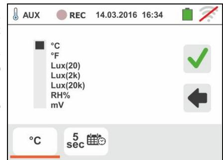
Toque el icono para configurar los parámetros del registro. La siguiente pantalla se muestra en el visualizador
