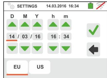
**La fecha/hora interna se mantiene en el instrumento en ausencia de pilas durante aproximadamente 12 horas**
