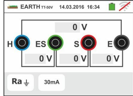
Toque el primer Icono inferior izquierdo para configurar el modo de medida. La siguiente pantalla se muestra en el visualizador
