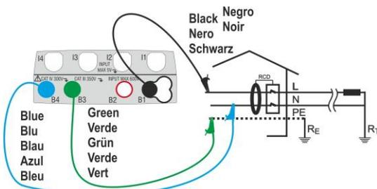
Fig. 12: Conexionado en sistema monofásico con cables y punta remota
