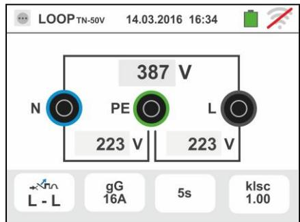
8. Pulse la tecla **GO/STOP** para 2s o bien la tecla **START** sobre la punta remota. Durante toda esta fase no desconecte los terminales de prueba del instrumento en la instalación en examen.
