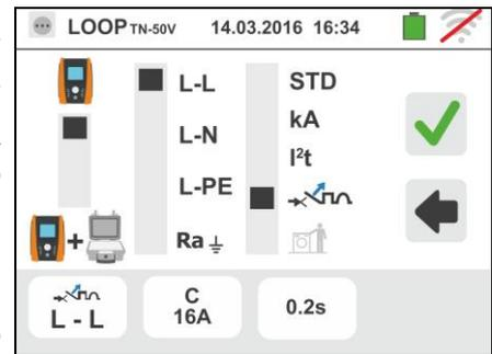
3. Desplace la referencia de la barra deslizante seleccionando el tipo de protección (Fusible de tipo **gG** o **aM** o magnetotérmico MCB en curva **B, C, K, D**)
