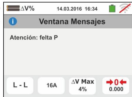
4. Si el instrumento obtiene la ausencia de la señal sobre el terminal B4 (conductor de neutro) proporciona la pantalla de aviso mostrada a la derecha y bloquea el desarrollo de las pruebas
