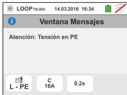
9. Si se obtuviera la presencia de una tensión VN-PE >50V (o bien > 25V en base a la selección) el instrumento no efectúa la prueba y muestra una pantalla como la siguiente
