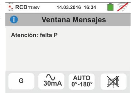
4. Si el instrumento detecta ausencia de señal sobre el terminal B4 (conductor de neutro) muestra la pantalla de aviso de la derecha y se bloquea la prueba
