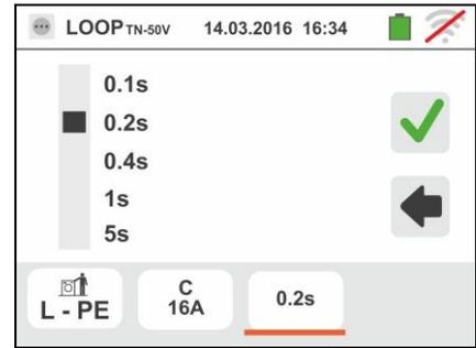
6. Desconecte, cuando sea posible, todas las cargas conectadas aguas abajo del punto de prueba en cuanto la impedancia de dichas cargas podría influenciar los resultados de la prueba. Conecte la toma shuko, los cocodrilos o la punta remota a la red eléctrica de acuerdo con las Fig. 17, Fig. 18, Fig. 19 y Fig. 21 en el punto más lejos de la protección
