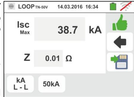
6. En caso de resultado negativo de la prueba (corriente Isc Max medida > umbral límite configurado) la pantalla de la derecha se muestra en el instrumento
