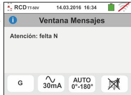
5. Si el instrumento detecta la ausencia de señal sobre el terminal B3 (conductor PE) muestra la pantalla de aviso de la derecha y se bloquea la prueba
