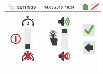
Desplace la referencia de la barra deslizante de la sección “ ” hacia arriba/abajo para activar/desactivar el autoapagado del instrumento luego de un período de inactividad de 5 minutos
