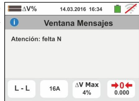
5. Si el instrumento obtiene la ausencia de la señal sobre el terminal B3 (conductor PE) proporciona la pantalla de aviso mostrada a la derecha y bloquea el desarrollo de las pruebas.
