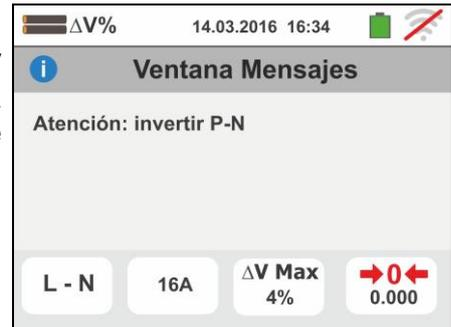
7. Si se detecta que los terminales de fase y PE están intercambiados el instrumento no efectúa la prueba y muestra una pantalla como la de la derecha. Controle el conexionado de los cables de medida
