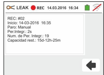
10 Pulse la tecla **GO/STOP** para terminar el registro que el instrumento guarda automáticamente en memoria (vea el § 7.1.3). El mensaje siguiente se muestra en pantalla de la derecha.
