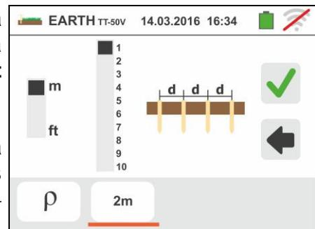
Desplace la referencia de la barra deslizante en la parte derecha para seleccionar la distancia “d” entre las sondas de prueba eligiendo entre **1m ÷ 10m (3ft ÷ 30ft)**
