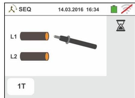
7. El símbolo de la punta sobre la fase L2 y el reloj de arena que indica la condición de espera del reconocimiento de una tensión superior al límite máximo permitido
