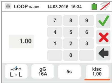
7. Desconecte, cuando sea posible, todas las cargas conectadas aguas abajo del punto de prueba en cuanto la impedancia de dichas cargas podría influenciar los resultados de la prueba. Conecte la toma shuko, los cocodrilos o la punta remota a la red eléctrica de acuerdo con las Fig. 17, Fig. 18, Fig. 19 y Fig. 21 en el punto más lejos de la protección
