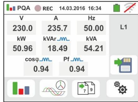
9. Toque el icono
