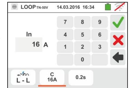
5. Desplace la referencia de la barra deslizante seleccionando el tiempo de intervención de la protección entre las opciones: **0.1s, 0.2s, 0.4s, 1s, 5s**
