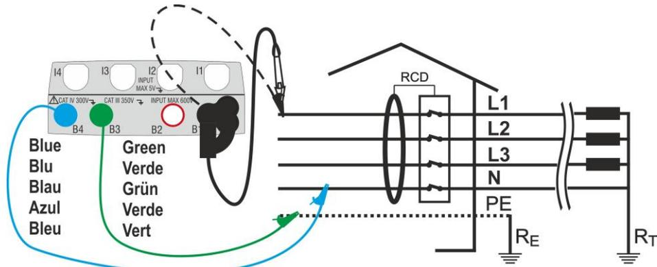
Fig. 13: Conexión en sistema trifásico con cables y punta remota
