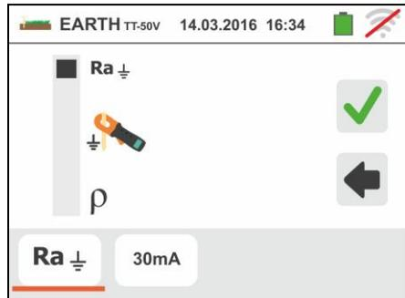
Toque el segundo Icono inferior izquierdo para configurar la corriente de intervención del diferencial (**sistemas TT y IT**). La siguiente pantalla se muestra en el visualizador
