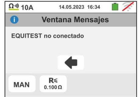
2. Si intenta establecer un valor de umbral límite en la medida de resistencia fuera del rango de medición permitido, el instrumento muestra la pantalla al lado. Establecer el valor límite en el rango: **0.003 $\Omega$  ÷ 0.500 $\Omega$**
