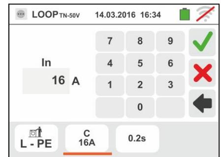
5. Desplace la referencia de la barra deslizante seleccionando el tiempo de intervención de la protección entre las opciones: **0.1s, 0.2s, 0.4s, 1s, 5s**
