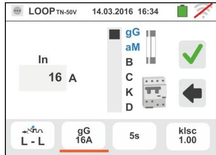
4. Toque el icono para poner a cero el valor en el campo In y utilice el teclado virtual para configurar el valor de la corriente nominal de la protección entre los valores permitidas por el instrumento
