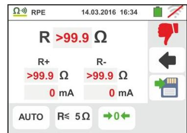
El valor se muestra en rojo y el símbolo
