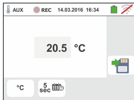
6. Pulse la tecla **GO/STOP** para activar el registro. El instrumento se pone en espera (del minuto siguiente o de la fecha/hora configurada) mostrando el símbolo "REC" en pantalla como se muestra en la pantalla de al lado.
