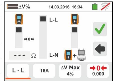
7. Toque el icono para poner a cero el valor en el campo “Ω” y utilice el teclado virtual para definir el valor de la impedancia **Offset Z1** en el rango **0.000Ω** a **9999Ω**. Confirme la elección volviendo a la pantalla precedente.
