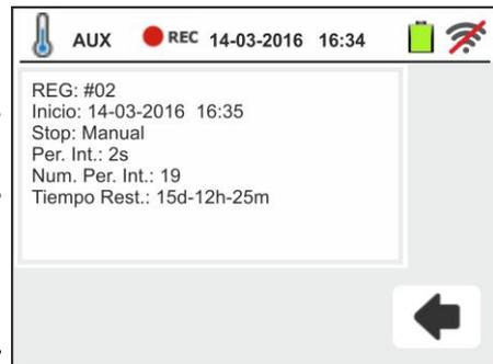
9. Pulse la tecla **GO/STOP** para terminar el registro que el instrumento guarda automáticamente en memoria (vea el § 7.1.3). El mensaje de al lado se muestra en pantalla.
