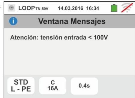
3. Si el instrumento obtiene la ausencia de la señal sobre el terminal B1 (conductor de fase) proporciona la pantalla de aviso mostrada a la derecha y bloquea el desarrollo de las pruebas
