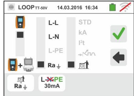
3. Desplace la referencia de la barra deslizante izquierda seleccionando el valor de la corriente de intervención del RCD entre los valores: **10,30,100,300,500,650,1000mA**
