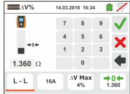
8. Toque el icono para poner a cero el valor en el campo “A” y utilice el teclado virtual para configurar el valor de la corriente nominal de la protección comprendido entre **1A** y **9999A**. Confirme la elección volviendo a la pantalla anterior. Toque el tercer icono abajo a la izquierda para configurar el valor límite máximo admitido en la caída de tensión ( $\Delta V\%$ ) para la línea en examen. Se muestra la siguiente pantalla en el visualizador
