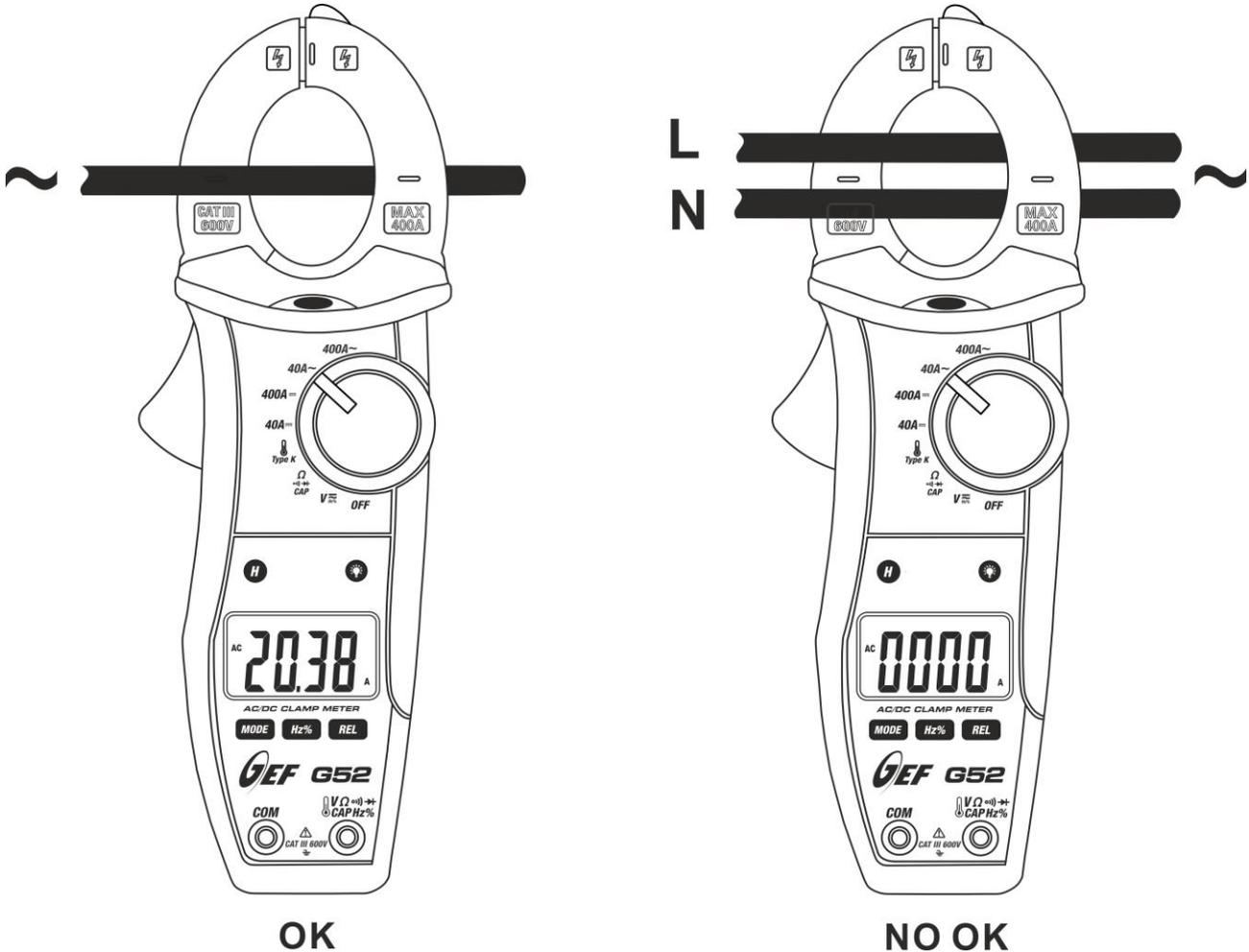
Fig. 11: Uso de la pinza para medidas de corriente CA
