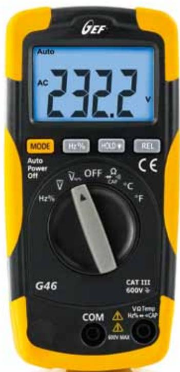
Multímetro digital de **4000 puntos de medida** que realiza principalmente medidas de **tensión CA/CC**. Entre las muchas funcionalidades del instrumento están comprendidas las medidas de capacidades, frecuencia, temperatura, prueba de diodos, ciclo de trabajo, etc. El multímetro dispone de la función de autoapagado para preservar la vida útil de la pila interna.
