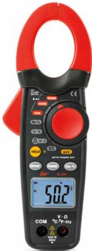
La pinza amperimétrica G34 está diseñada para la medida de **corriente CA hasta 1000A** y **Tensión CA/CC hasta 600V** para el alcance de la **CAT III 600V** de acuerdo con la norma **IEC/EN61010-1**. La pinza está dotada de un amplio **visualizador retroiluminado a 4000 puntos de medida** y de una función de autoapagado para preservar la duración de la batería.
