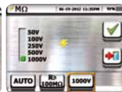
Selección tensión de prueba y valor límite mínimo sobre la medida
