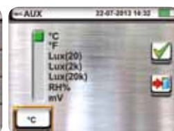
Selección tipo medida con sonda externa
