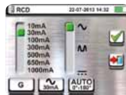
Selección tipo y corriente de intervención RCD
