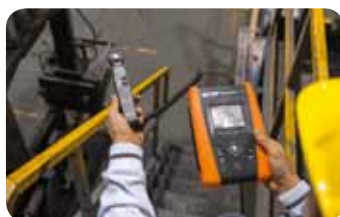
Medida de lux con accesorio HT53/05.
