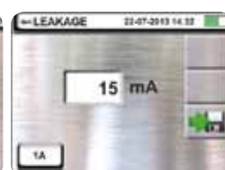
Medida de la corriente de fugas con pinza opcional HT96U
