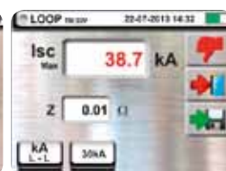
Resultado negativo verificación del poder de interrupción
