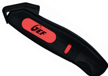
Preciso, veloz y fiable para pelar cables circulares de diámetro 4-28 mm<sup>2</sup>. Dotado de adaptadores intercambiables de plástico de elevada resistencia (POM). Gracias al dispositivo de regulación variable de la profundidad de corte no daña los conductos internos.
