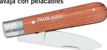
Navaja con pelacables para electricista. Hoja con filo de punta triangular con hendido en hoja redonda para pelar cables. Empuñadura de madera y longitud del filo de corte 85 mm.
