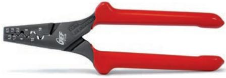
Prensa terminales desde 0,5 a 16mm<sup>2</sup> para terminales de acuerdo con la norma DIN46228 de acero oscurecido con perfil de presión trapezoidal.
