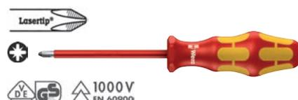
**Aplicación:** para tornillos Pozidriv · **Varilla:** aislada · **Punta:** ISO 8764-PZ, Lasertip® · **Empuñadura:** Kraftform® con protección antideslizamiento, multi componente.
