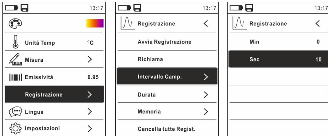
Fig. 31: Funzione data logger – Impostazione intervallo di campionamento
