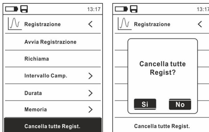
Fig. 38: Funzione data logger – Cancellazione di tutte le registrazioni
