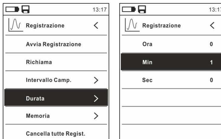
Fig. 32: Funzione data logger – Impostazione durata registrazione
