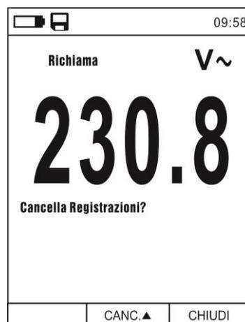
Fig. 36: Funzione data logger – Cancellazione registrazione
