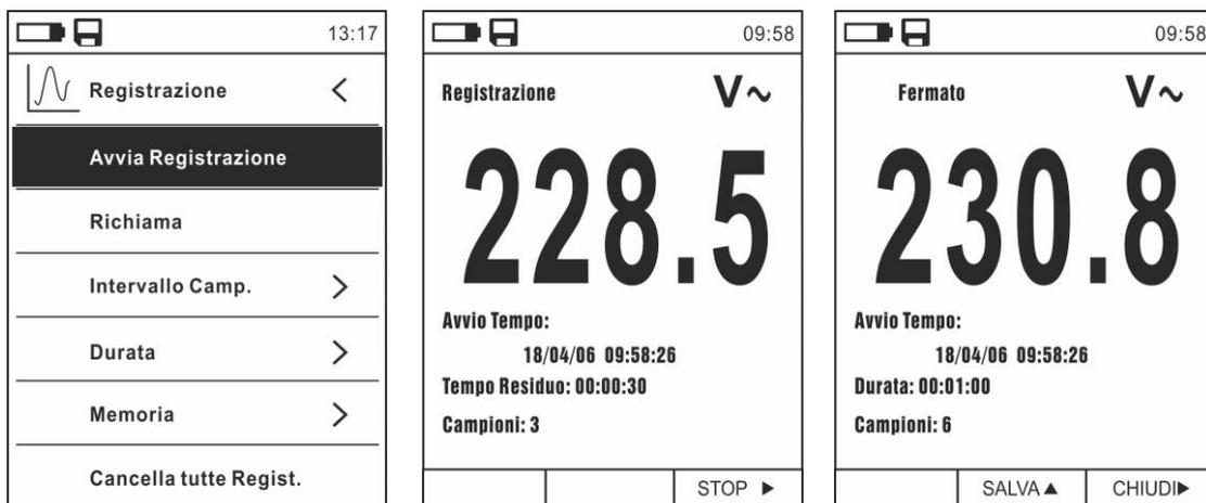
Fig. 33: Funzione data logger – Avvio e terminazione registrazione
