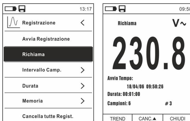
Fig. 34: Funzione data logger – Richiamo a display dati registrazione
