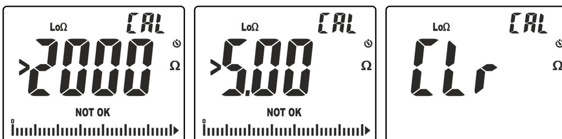
Fig. 35: Azeramento de uma calibração
