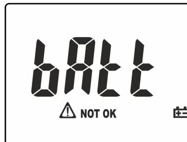
Fig. 43: Ecrã com a indicação de bateria descarregada
