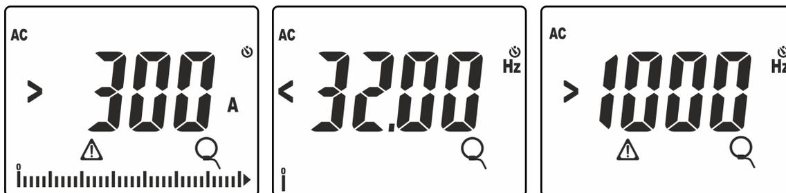
Fig. 39: Situações anómalas na medição da corrente com transdutores com pinça
