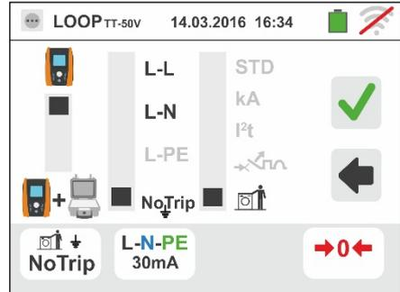
3. Mover a barra deslizante esquerda seleccionando o valor da corrente de intervenção do RCD entre os valores: **6,10,30,100,300,500,650,1000mA**.
