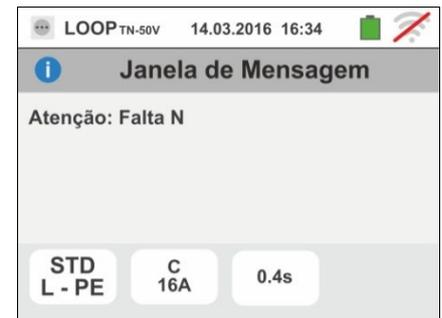
5. Se o instrumento detecta a ausência do sinal no terminal B3 (condutor PE) fornece o ecrã de aviso mostrado ao lado e bloqueia o desenrolar dos testes.
