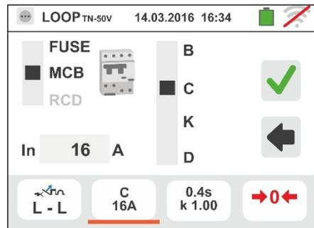
4. Tocar o ícone para colocar em zero o valor no campo In e usar o teclado virtual para configurar o valor da corrente nominal da proteção entre os valores permitidos pelo instrumento
