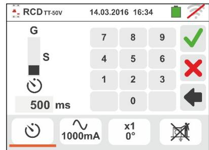
4. Mover a referência da barra deslizante esquerda seleccionando o tipo de RCD entre as opções: **STD** (diferenciais do tipo **Standard**) e
