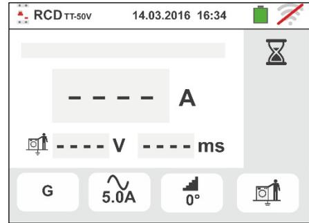
10 No final do teste, se a corrente de disparo for inferior ao configurado, o instrumento apresenta o símbolo
