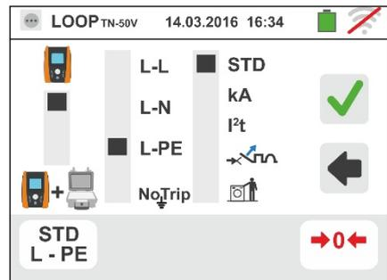
3. Desligar, quando possível, todas as cargas conectadas a jusante do ponto de medição visto que a impedância desses utilitários poderá influenciar os resultados do teste.
