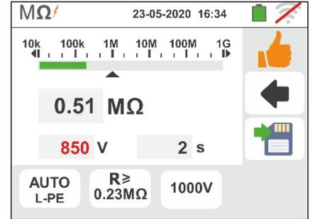
2. **Na medida L/N-PE** se o instrumento medir uma resistência maior do que o limite definido, mas para o qual não pode gerar a tensão nominal, no display aparece o ecrã apresentado ao lado
