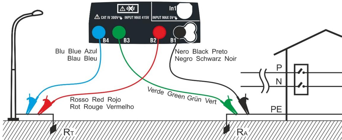
Fig. 29: Medição da resistência de terra com 2 fios com ponteira auxiliar
