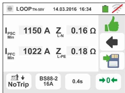
No caso de resultado positivo ( $Z_{L-PE}$  OU  $Z_{L-N}$  **MENOR** ou **EQUAL** a impedância limite relativa do dispositivo da protecção no tempo especificado) É apresentado, pelo instrumento, o ecrã mostrado ao
