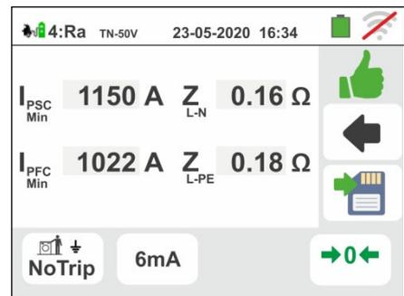
Pressione o botão **SAVE** ou o ícone
