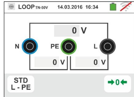
6. O valor da resistência dos cabos de teste/ficha Shuko/várias fichas é mantido pelo instrumento até à operação de reposição efetuada pelo utente (por exemplo para a introdução de cabos com diferentes comprimentos).
