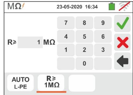
5. Tocar o ícone “xxxxV” para configurar a tensão de teste CC na medição de isolamento. No display aparece o ecrã apresentado ao lado
