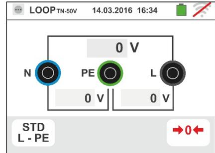
2. Tocar o ícone para selecionar a calibração dos cabos de teste ou o ícone para selecionar a calibração do cabo com ficha Shuko como se mostra no ecrã seguinte
