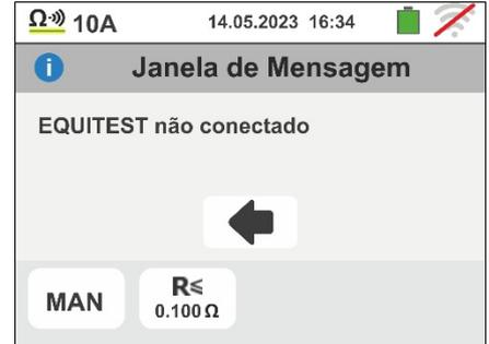
2. Se você tentar definir um valor limite na medição de resistência fora da escala de medição permitida, a tela ao lado é mostrada pelo instrumento. Defina o valor limite no escala: **0.003Ω ÷ 0.500Ω**
