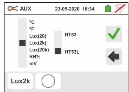
3. **Se a sonda HT53L for usada**, selecione a cor da fonte de LED sendo testada nas opções: (**fonte de luz branca padrão**) ou (**fonte de luz LED/Coloridas**), conforme mostrado na tela ao lado
