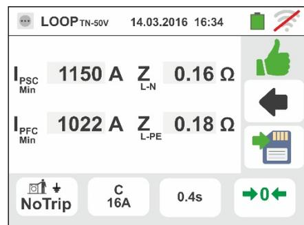
No caso de resultado positivo ( **$Z_{L-PE}$  MENOR ou EQUAL a impedância limite relativa do dispositivo da protecção no tempo especificado**) É apresentado, pelo instrumento, o ecrã mostrado ao
