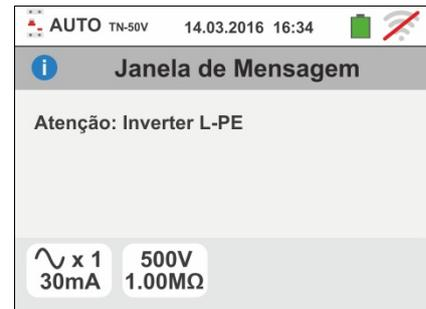
8. Quando o interruptor diferencial em exame intervém durante a fase de pré-teste (executado de modo automático pelo instrumento antes de efectuar o teste seleccionado), o instrumento não executa o teste e apresenta um ecrã como o mostrado ao lado. Verificar se o valor de IdN configurado está de acordo com o interruptor diferencial em exame e se todas as cargas ligadas a jusante do mesmo estão desconectadas
