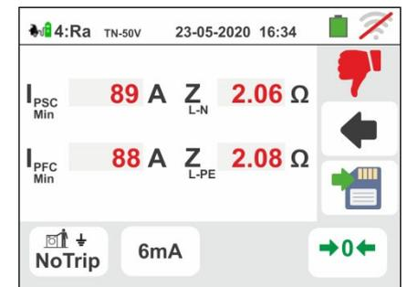
Pressione o botão **SAVE** ou o ícone
