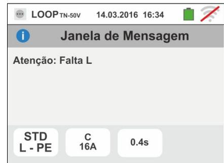
4. Se o instrumento detecta a ausência do sinal no terminal B4 (condutor de neutro) fornece o ecrã de aviso mostrado ao lado e bloqueia o desenrolar dos testes.
