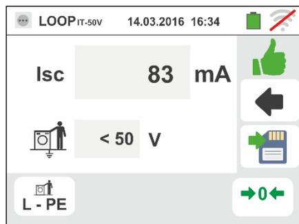
5. No caso de resultado negativo (tensão de contacto no ponto >50V ou >25V) É apresentado, pelo instrumento, o ecrã mostrado ao lado). Notar a presença do resultado da medição de tensão de contacto evidenciado a vermelho.
