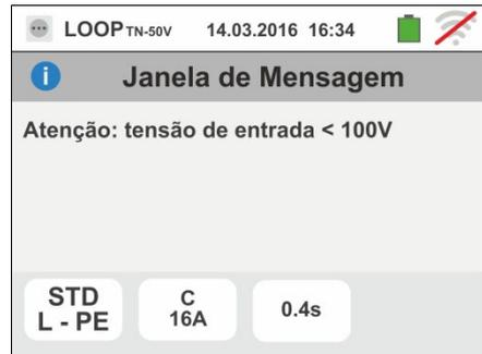
3. Se o instrumento detecta a ausência do sinal no terminal B1 (condutor de fase) fornece o ecrã de aviso mostrado ao lado e bloqueia o desenrolar dos testes.
