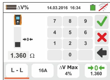
4. Tocor o ícone
