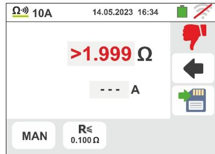
8. **No caso de medição AUTO**, o instrumento **entra em modo de espera** e exibe a tela ao lado após realizar um teste.
