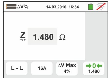
9. Ligar o instrumento no ponto final da linha em exame de acordo com as Fig. 34 ou Fig. 35 de modo a executar a medição da Impedância no fim da linha **Z2**. No display é apresentado o ecrã mostrado ao lado. Notar a presença no display do valor Z1 (Offset) anteriormente medido
