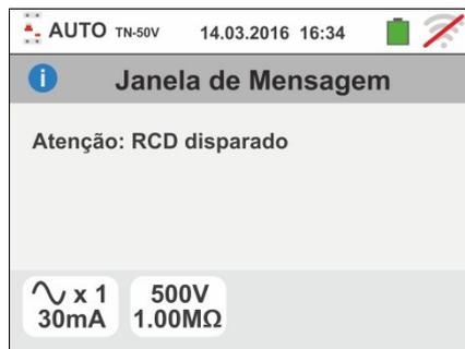
9. Quando é detetada a presença de uma tensão perigosa no terminal PE, o instrumento não efetua o teste e apresenta um ecrã como o mostrado ao lado. **Esta mensagem também pode ser apresentada devido a uma pressão insuficiente do botão GO/STOP**
