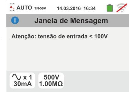
3. Se o instrumento deteta a ausência de sinal no terminal B1 (condutor de fase) apresenta o ecrã de aviso mostrado ao lado e bloqueia o desenrolar dos testes
