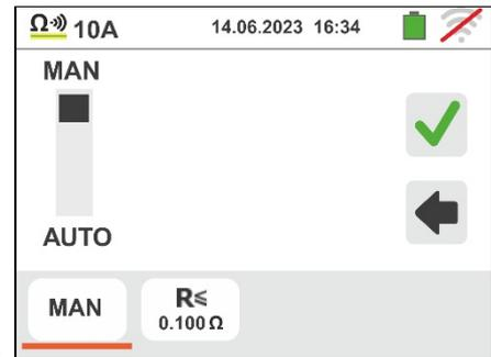
4. Toque no cone para redefinir o valor no campo "Ω" e use o teclado virtual para definir o valor da resistência limite máxima usada pelo instrumento para avaliar o teste de continuidade no campo: **0.003Ω ÷ 0.500Ω** em passos de **0.001Ω**. Confirme sua escolha voltando para a tela anterior
