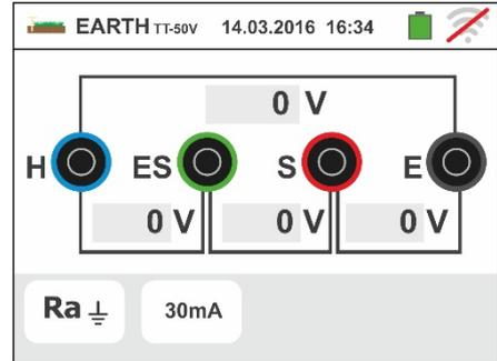
2. Mover a barra deslizante para a posição “ $Ra \perp$ ” para a selecção da medição de terra pelo método voltamperimétrico, para a posição para a medição de resistência com uso de pinça opcional T2100 (ver § 6.7.2) ou para a posição “ $\rho$ ” para a medição da resistividade do terreno. Confirmar a escolha voltando ao ecrã inicial da medição.
