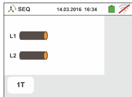
2. Mover a barra deslizante na posição “1T” para a selecção do teste com 1 terminal ou na posição “2T” para a selecção do teste com 2 terminais.
