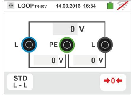
2. Mover a barra deslizante esquerda seleccionando o ícone para a execução da medição só com o instrumento ou o ícone para a execução da medição com instrumento + acessório opcional IMP57 (ver § 6.4.13).
