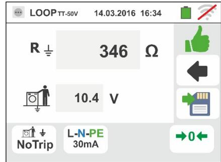
6. No caso de resultado negativo (resistência total de terra superior à relação entre a tensão de contacto limite e a corrente de intervenção do RCD) É apresentado, pelo instrumento, o ecrã mostrado ao lado.
