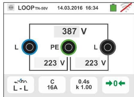
8. Premir para 2s o botão **GO/STOP por alguns segundos** ou o botão **START** na ponteira remota. Durante toda esta fase não desconectar os terminais de medida do instrumento da instalação em exame. No caso de resultado positivo (corrente de curto-circuito mínima interrompida pelo dispositivo de proteção no tempo indicado pelas seleções efetuadas), o instrumento apresenta o ecrã mostrado ao lado. Premir
