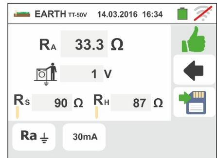
7. Para a **medição da resistência de terra nos sistemas TT**, nos casos de resultado negativo É apresentado, pelo instrumento, o ecrã mostrado ao lado em que aparece o valor da tensão de contacto no display secundário, o valor da resistência de contacto da sonda de tensão ( $R_s$ ) e o valor da resistência de contacto da sonda de corrente ( $R_h$ ). Notar a presença do resultado da medição evidenciado a vermelho.
