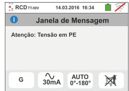
10. Se o instrumento detecta uma tensão de contacto  $U_t$  perigosa (superior ao limite configurado 25V ou 50V) no pré-teste inicial, não executa o teste e apresenta a mensagem mostrada ao lado. Verificar a eficiência do condutor PE e da instalação de terra.
