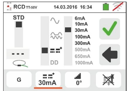
67 **O modo Rampa está fixo no instrumento.** Mova a referência da barra deslizante inferior selecionando o tipo de exibição da corrente de disparo durante o teste de rampa nas opções "**NOM**" ou "**REAL**" (consulte o parágrafo (consulte o § 6.3).
