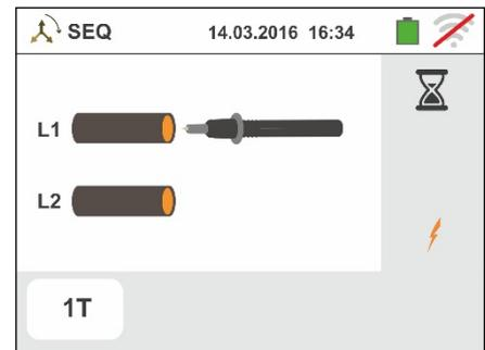
6. No final da aquisição da fase L1 o instrumento coloca-se na condição de espera pelo sinal na fase L2 mostrando o símbolo “desligar a ponteira” conforme mostrado no ecrã ao lado.
