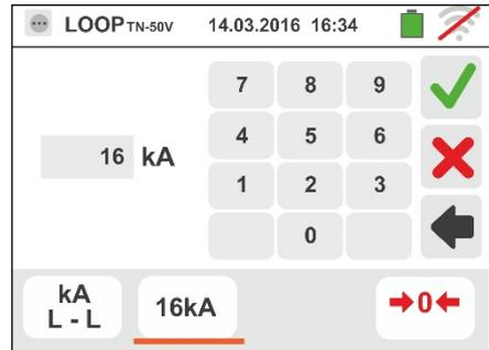
4. Desligar, quando possível, todas as cargas conectadas a jusante do ponto de medição visto que a impedância dos referidos utilitários poderá influenciar os resultados do teste. Efetuar a calibração preliminar dos terminais de teste conforme o descrito no § 6.4.2. Conectar a ficha shuko, os crocodilos ou a ponteira remota à rede eléctrica de acordo com as Fig. 18, Fig. 19, Fig. 20 e Fig. 22 no ponto mais próximo possível da protecção em exame
