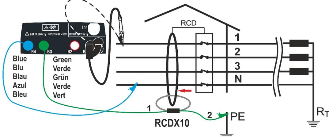
Fig. 17: Ligação RCD com toróide separado com acessório opcional RCDX10
