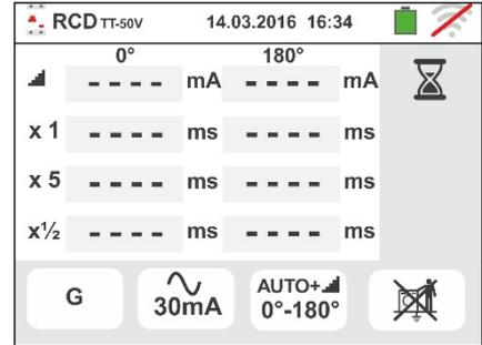
10 O modo AUTO+ prevê a execução automática de 6 medições em sequência:
