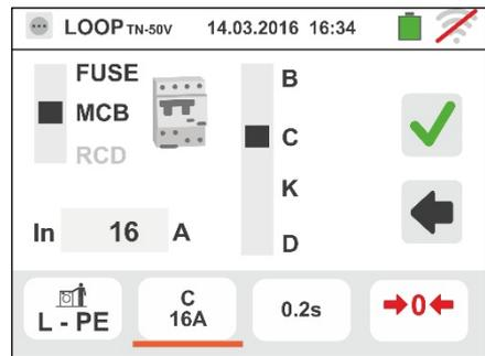
4. Tocar o ícone para colocar em zero o valor no campo IN e usar o teclado virtual para configurar o valor da corrente nominal da protecção entre os valores permitidos pelo instrumento (ver § 6.4.5).
