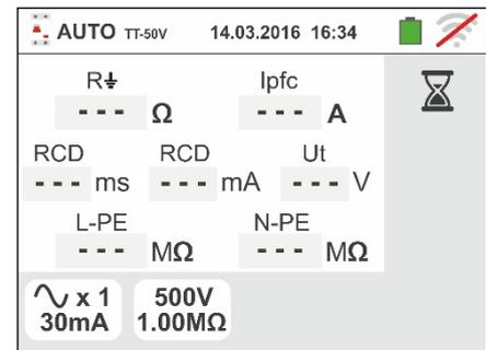
8. No caso de resultado **positivo** dos três testes, efetuados em sequência **NoTrip**, **RCDX1** e **MΩ L/N-PE**, o instrumento apresenta o símbolo e no display aparece o ecrã mostrado ao lado.
