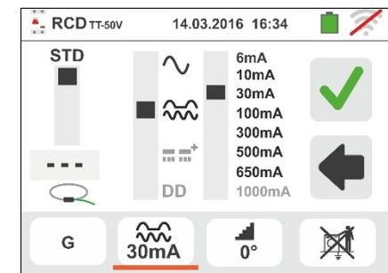
59 **O modo Rampa está fixo no instrumento.** Mova a referência da barra deslizante inferior selecionando o tipo de exibição da corrente de disparo durante o teste de rampa nas opções "**NOM**" ou "**REAL**" (consulte o parágrafo (consulte o § 6.3).
