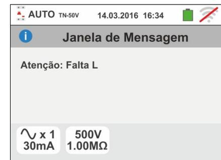
4. Se o instrumento deteta a ausência de sinal no terminal B4 (condutor de neutro) apresenta o ecrã de aviso mostrado ao lado e bloqueia o desenrolar dos testes
