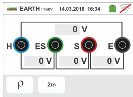
Tocar o ícone à direita para configurar a unidade de medida e a distância entre as sondas de teste. No display é apresentado o seguinte ecrã.
