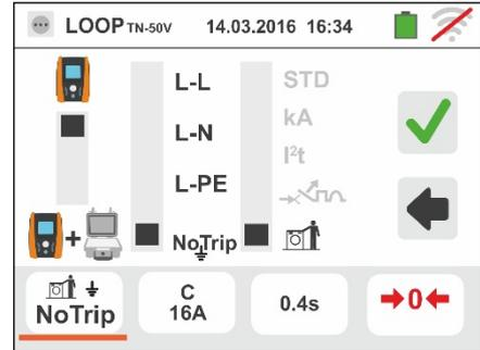
3. Mover a barra deslizante seleccionando o tipo de protecção (Fusível do tipo **BS88-2**, **BS88-3**, **BS3036**, **BS1362** ou magnetotérmico MCB em curva **B**, **C**, **D**) ou corrente nominal RCD entre valores **6**, **10**, **30**, **100**, **300**, **500**, **650**, **1000mA**.
