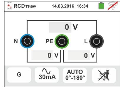
2. Mover a barra deslizante seleccionando o tipo de funcionamento pretendido entre as opções: **G** (Geral), **S** (Selectivo),
