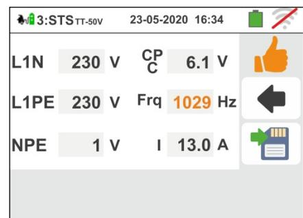
33 Se o teste falhar, a imagem como a lateral é mostrada no ecrã. O valor incorreto do parâmetro é mostrado em vermelho e o símbolo indica o resultado não aprovado da medição. Pressione o botão **SAVE** ou o ícone para guardar parcialmente o teste e **terminar a sequência de teste**. O instrumento mostra a mensagem mostrada na tela a seguir por alguns segundos
