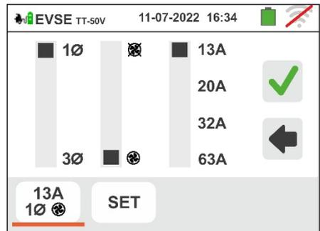
Mova a referência da barra deslizante direita selecionando a corrente de saída nominal máxima do sistema EVSE, conforme definido pelo padrão de referência, entre as opções: **13A, 20A, 32A e 63A**
