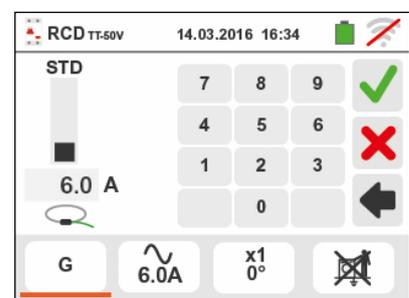
6. Mover a barra deslizante esquerda seleccionando o tipo de teste pretendido entre as opções:
