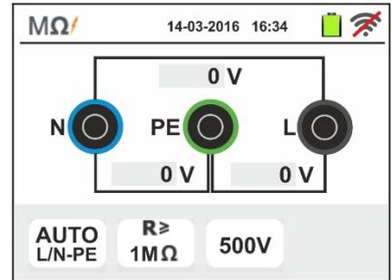
2. Mover a barra deslizante esquerda nas posição “AUTO” (modo Automático). Mover a barra deslizante direita nas posições “L/N-PE”. Confirmar a escolha voltando ao ecrã anterior.
