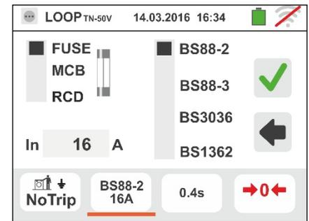
4. Tocar o ícone para colocar em zero o valor no campo IN e usar o teclado virtual para configurar o valor da corrente nominal da protecção entre os valores permitidos pelo instrumento (ver § 6.4.5).
