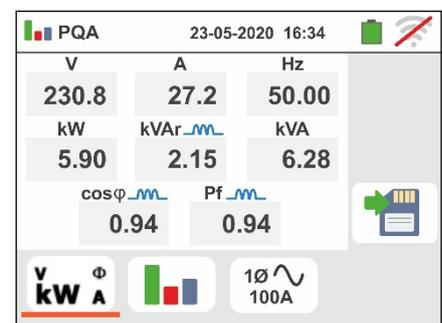
6. O ecrã ao lado mostra os valores das parametros elétricas em tempo real em uma caixa Trifase balanceado. Os símbolos "" e "" indicam, respectivamente, o Carácter Indutivo ou Capacitivo da Carga.
