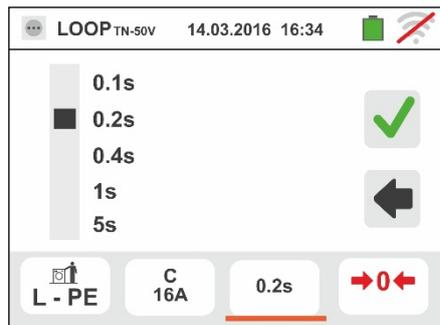
6. Desligar, quando possível, todas as cargas conectadas a jusante do ponto de medição visto que a impedância dos referidos utilitários poderá influenciar os resultados do teste. Efetuar a calibração preliminar dos terminais de teste conforme o descrito no § 6.4.2. Conectar a ficha shuko, os crocodilos ou a ponteira remota à rede eléctrica de acordo com as Fig. 18, Fig. 19, Fig. 20 e Fig. 22 no ponto mais afastado possível da protecção em exame
