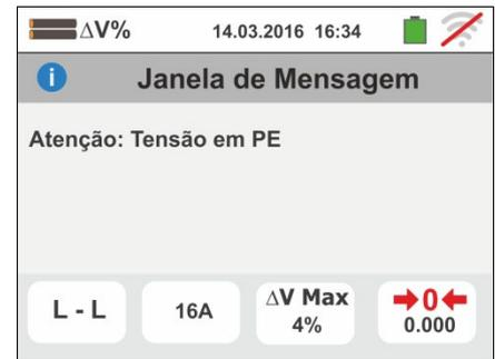
9. Quando é detetada a presença de uma tensão VN-PE >50V (ou > 25V em função da seleção), o instrumento não efetua o teste e apresenta um ecrã como o mostrado ao lado
