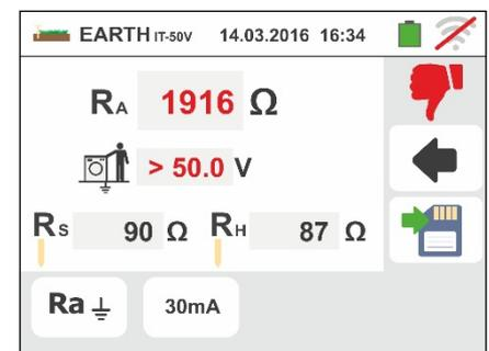
9. Para a **medição da resistência de terra nos sistemas TN**, nos casos de resultado positivo É apresentado, pelo instrumento, o ecrã mostrado ao lado em que aparece o valor da tensão de contacto no display secundário, o valor da resistência de contacto da sonda de tensão ( $R_s$ ) e o valor da resistência de contacto da sonda de corrente ( $R_h$ ).
