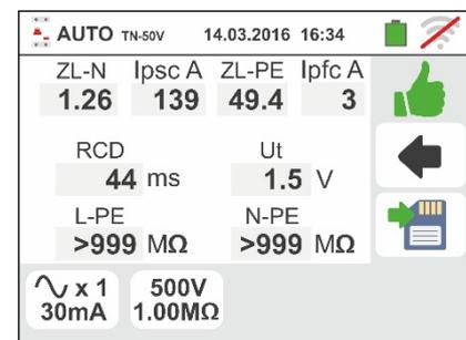
9. No caso de resultado **positivo** dos três testes efetuados na sequência **NoTrip $\frac{1}{2}$**  (**ZL-N** e **ZL-PE<199Ω**), **RCD** e **MΩ L/N-PE**, o instrumento apresenta o símbolo e no display aparece o ecrã mostrado ao lado.
