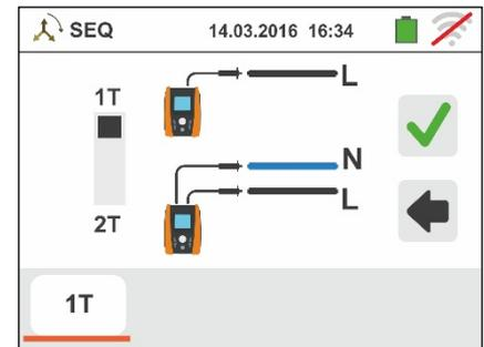
3. Inserir os conectores azul e preto dos cabos individuais nos correspondentes terminais de entrada do instrumento B4, B1 (medição 2T). Inserir nas extremidades livres dos cabos os correspondentes crocodilos ou ponteiras. Eventualmente, utilizar a ponteira remota inserindo o seu conector multipolar no terminal de entrada B1. Conectar os crocodilos, ponteiras ou a ponteira remota na fase L1 e N de acordo com as Fig. 24 e Fig. 25.
