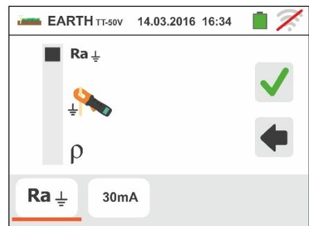
Tocor o segundo ícone em baixo à esquerda para configurar a corrente de intervenção do diferencial (**sistemas TT e IT**). No display é apresentado o seguinte ecrã
