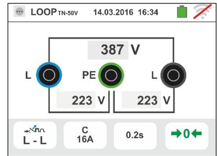
7. Premir o botão **GO/STOP por alguns segundos** ou o botão **START** na ponteira remota. Durante toda esta fase não retirar os terminais de medida do instrumento da instalação em exame. No caso de resultado positivo (corrente de curto-circuito mínima interrompida pelo dispositivo de protecção no tempo indicado pelas selecções efectuadas) É apresentado, pelo instrumento, o ecrã mostrado ao lado. Premir o botão
