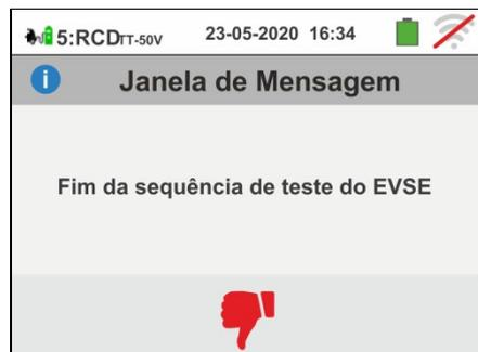
Test 6 → Teste RCD tipo B/B+ ou DD do sistema EVSE
