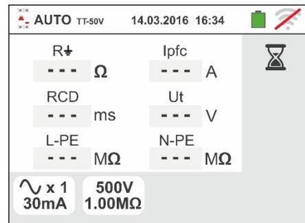
7. Premir o botão **GO/STOP durante alguns segundos** ou o botão **START** na ponteira remota para ativar o teste. Durante toda esta fase não desconectar os terminais de medida do instrumento da instalação em exame. No caso da seleção da **medição da corrente de disparo do RCD** no display aparece o ecrã mostrado ao lado em que o ícone da ampulheta indica o desenrolar do teste
