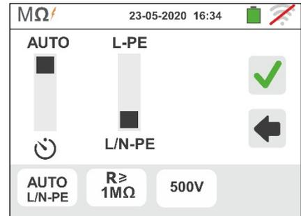
3. Tocar o ícone “R≥xxΩ” para configurar o valor limite mínimo da resistência de isolamento sobre o qual o instrumento executa a comparação com o valor medido. No display aparece o ecrã apresentado ao lado
