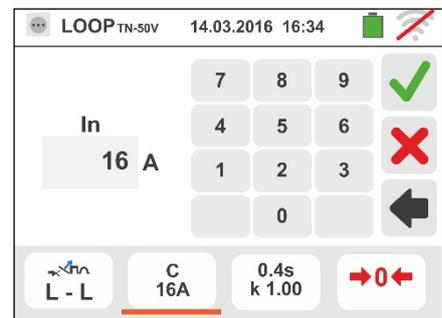
5. Mover a referência da barra deslizante selecionando o tempo de disparo da proteção entre as opções: **0.1s**, **0.2s**, **0.4s**, **1s**, **5s**. Confirmar a escolha voltando para o ecrã anterior. Tocor o campo “k Isc” para configurar o coeficiente de cálculo da corrente de curto-circuito **Isc**. É apresentado o seguinte ecrã
