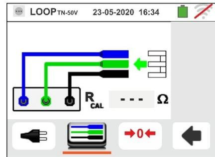
3. Inserir o acessório metálico **ZEROLOOP** nos três conetores de banana dos cabos de teste (L-N-PE) ou nos conetores metálicos da ficha Shuko (de forma diferente nos vários tipos, dependendo do país de utilização) como se mostra na seguinte Tabela 3
