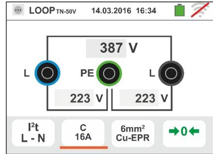
7. Premir o botão **GO/STOP por alguns segundos** ou o botão **START** na ponteira remota. Durante toda esta fase não retirar os terminais de medida do instrumento da instalação em exame.
