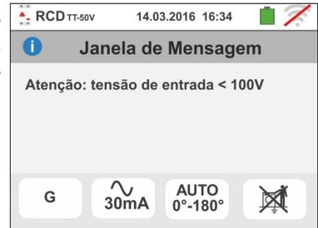
3. Se o instrumento detecta a ausência do sinal no terminal B1 (condutor de fase) fornece o ecrã de aviso mostrado ao lado e bloqueia o desenrolar dos testes.
