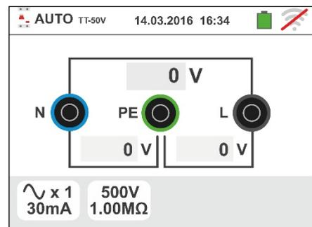
2. Mover a referência da barra deslizante esquerda seleccionando a forma de onda do diferencial entre as opções: (tipo AC), (tipo A/F), (tipo B/B+). Mover a referência da barra deslizante central seleccionando a corrente de disparo nominal entre as opções: **6mA, 10mA, 30mA, 100mA, 300mA**. Mover a referência da barra deslizante direita seleccionando o tipo de teste entre as opções:
