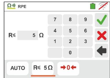
Tocar o ícone para colocar em zero o valor no campo “R≤”. Usar o teclado virtual para configurar o valor compreendido entre **0.01Ω** e **9.99Ω**.
