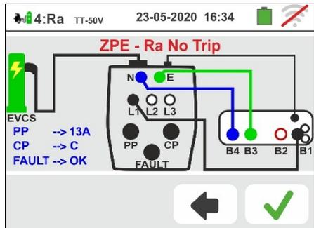
48 O teste é realizado pelo instrumento **apenas em modo "NoTrip"** . Consulte o § 6.4.9 para obter uma descrição da configuração dos parâmetros de teste relacionados à corrente de intervenção do RCD do sistema EVSE, **ausência de condutor neutro (somente possível medição)** e à calibração preliminar dos terminais de medição
