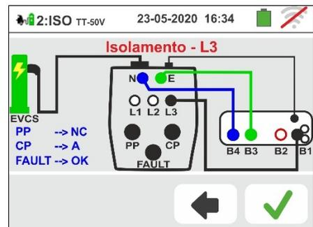
18 O resultado das medições dos testes **L3PE e NPE** é mostrado na imagem ao lado. Os valores das tensões reais de teste são mostrados no ecrã.
