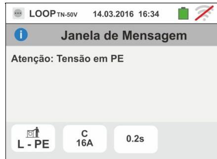
9. Quando é detectada a presença de uma tensão VN-PE >50V (ou > 25V dependendo da selecção) o instrumento não efectua o teste e apresenta um ecrã como o mostrado ao lado.
