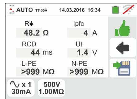
9. No caso de resultado **positivo** dos três testes, efetuados em sequência **NoTrip**, **RCD** e **MΩ L/N-PE**, o instrumento apresenta o símbolo e no display aparece o ecrã mostrado ao lado. Premir o botão **SAVE** ou tocar o ícone para guardar a medição (consultar o § 7.1). Premere il tasto **SAVE** o toccare l'icona per il salvataggio della misura (vedere § 7.1)
