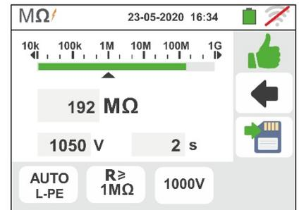
11. No final do teste, se o valor da resistência medida é inferior ao limite configurado, no display aparece o ecrã apresentado ao lado.
