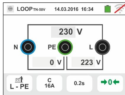
7. Premir o botão **GO/STOP por alguns segundos** ou o botão **START** na ponteira remota. Durante toda esta fase não retirar os terminais de medida do instrumento da instalação em exame.
