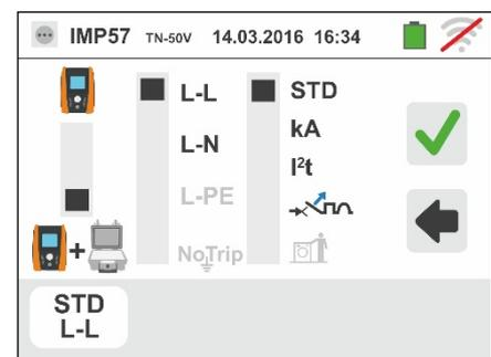
Mover a barra deslizante central seleccionando a opção “L-L”.
