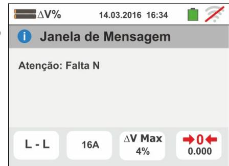
5. Se o instrumento deteta a ausência de sinal no terminal B3 (condutor PE) apresenta o ecrã de aviso mostrado ao lado e bloqueia o desenrolar dos testes.
