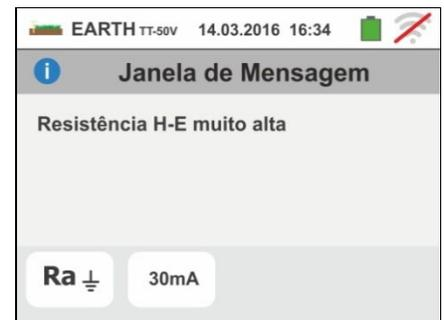
4. No início da medição, o instrumento verifica a situação das entradas B2 (S) e B3 (ES). No caso de inversão dos condutores na instalação, bloqueia o teste e mostra a mensagem apresentada ao lado.
