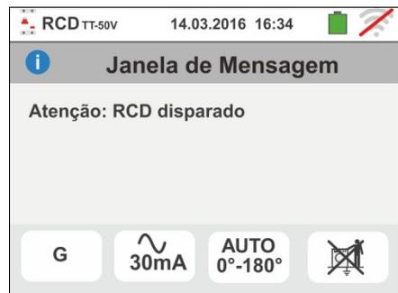
9. Se o instrumento detecta um potencial perigoso no condutor PE, bloqueia o teste e apresenta a mensagem mostrada ao lado. Verificar a eficiência do condutor PE e da instalação de terra.
