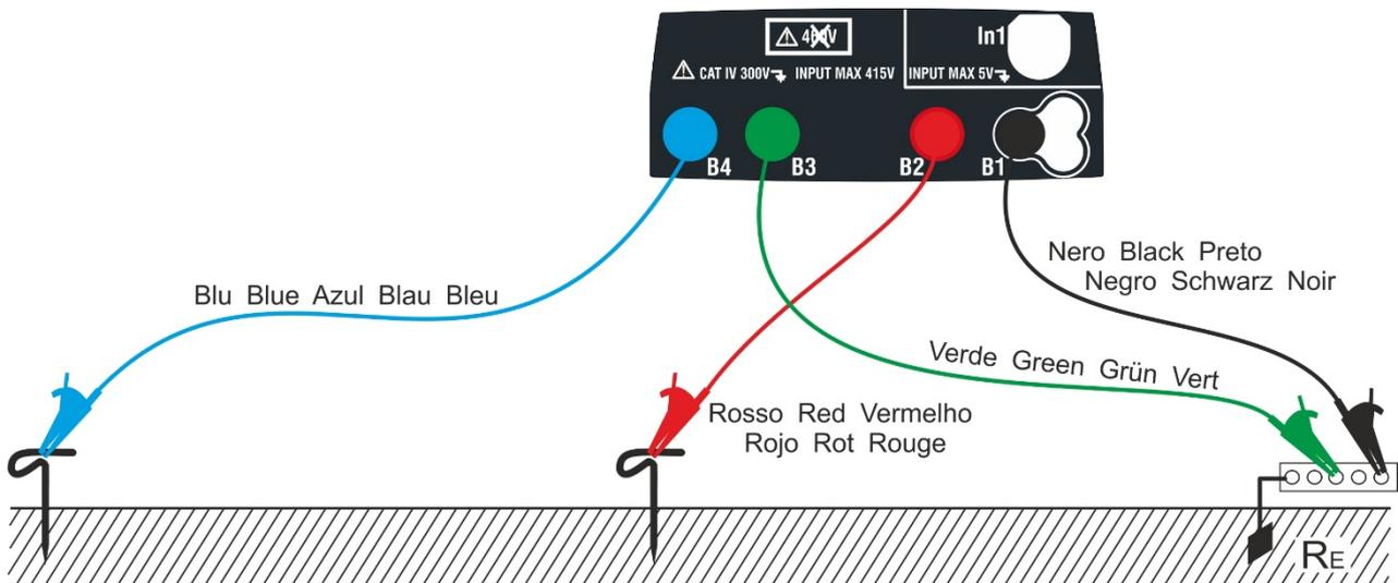
Fig. 28: Medição da resistência de terra com 3 fios
