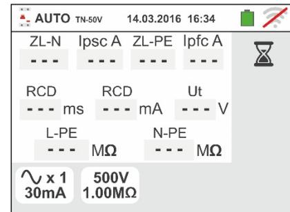
8. I No caso de resultado **positivo** dos três testes efetuados na sequência **NoTrip $\frac{1}{2}$**  (**ZL-N** e **ZL-PE<199Ω**), **RCDX1** e **MΩ L/N-PE**, o instrumento apresenta o símbolo e no display aparece o ecrã mostrado ao lado.
