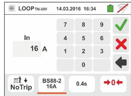
5. Mover a barra deslizante seleccionando o tempo de intervenção da protecção entre as opções: **0.4s**, **5s**
