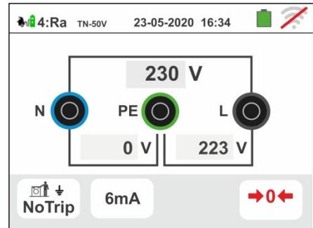
53 Durante toda esta fase, não desligar os terminais de medição do instrumento do sistema em questão. Se for bem sucedido ( $Z_{L-PE}$  ou  $Z_{L-N}$  **MENORES** ou **IGUAIS** à impedância limite relativa ao dispositivo de proteção no tempo especificado) a imagem ao lado é mostrada pelo instrumento
