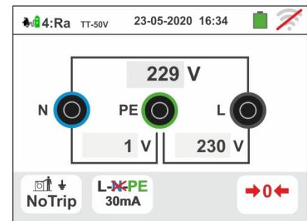
49 Durante toda esta fase, não desligar os terminais de medição do instrumento do sistema em questão. No caso de um resultado positivo (resistência geral à terra menor que a razão entre a tensão limite de contato e a corrente de disparo do RCD) a imagem ao lado é mostrada pelo instrumento no qual o valor da tensão de contato está presente no ecrã secundário.
