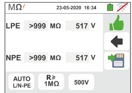
9. No final do teste, se o valor da resistência medida em um ou em ambos os testes é inferior ao limite configurado, no display aparece o ecrã apresentado ao lado.
