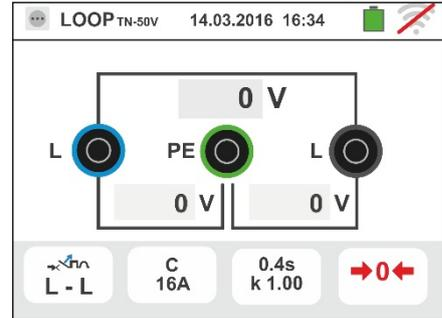
2. Mover a referência da barra deslizante esquerda selecionando o ícone para a execução da medição apenas com o instrumento ou o ícone para a execução da medição com o instrumento + acessório opcional IMP57 (consultar o § 6.4.13).
