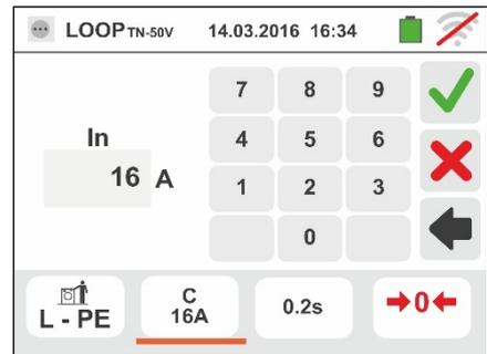
5. Mover a barra deslizante seleccionando o tempo de intervenção da protecção entre as opções: **0.1s**, **0.2s**, **0.4s**, **1s**, **5s** (todas paíes exceto AUS/NZ e UK), **0.4s**, **5s** (protecção Fusível para AUS/NZ e UK) e **0.4s** (protecção MCB para AUS/NZ)
