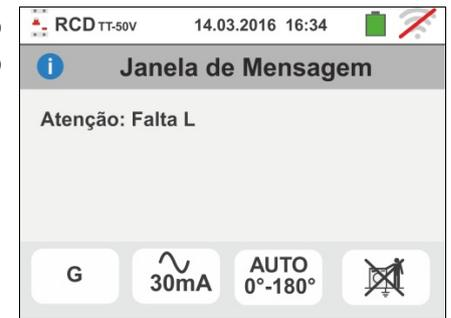
4. Se o instrumento detecta a ausência do sinal no terminal B4 (condutor de neutro) fornece o ecrã de aviso mostrado ao lado e bloqueia o desenrolar dos testes.
