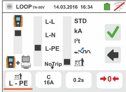
3. Mover a barra deslizante seleccionando o tipo de protecção (Fusível de tipo **gG** ou **aM** ou magnetotérmico MCB em curva **B**, **C**, **K**, **D**). (Fusível de tipo **BS88-2**, **BS88-3**, **BS3036**, **BS1362** ou magnetotérmico MCB em curva **B**, **C**, **D** – país **UK**). Para país **AUS/NZ** magnetotérmico MCB em curva **B**, **C**, **D**
