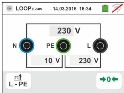
4. Premir o botão **GO/STOP por alguns segundos** ou o botão **START** na ponteira remota. Durante toda esta fase não retirar os terminais de medida do instrumento da instalação em exame. No caso de resultado positivo (tensão de contacto no ponto <50V ou <25V) É apresentado, pelo instrumento, o ecrã mostrado ao lado onde aparece o valor da corrente da primeira falha (Isc) medida expressa em mA. **Com Isc < 30mA o valor da Ut não é mostrado no display.** Premir o
