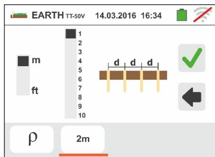
Mover a barra deslizante na parte direita para seleccionar a distância “d” entre as sondas de medida escolhendo entre **1m ÷ 10m (3ft ÷ 30ft)**.
