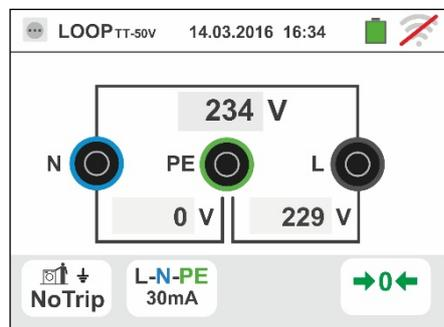
5. Premir o botão **GO/STOP** por alguns segundos ou o botão **START** na ponteira remota. Durante toda esta fase não retirar os terminais de medida do instrumento da instalação em exame.
