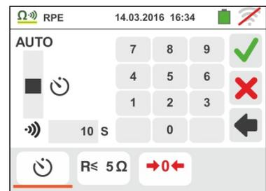
4. Tocar o ícone “R≤xxΩ” para configurar o valor limite máximo da resistência sobre o qual o instrumento executa a comparação com o valor medido. No display aparece o ecrã apresentado ao lado.
