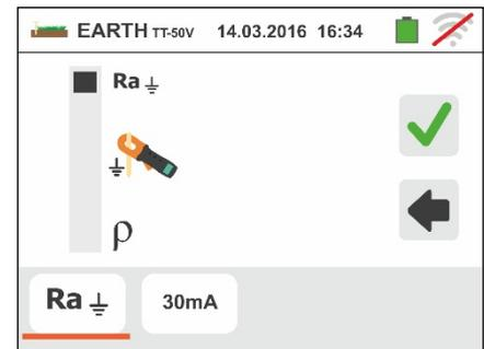
3. Mover a barra deslizante para a posição correspondente ao valor da corrente de intervenção do diferencial RCD conforme mostrado no ecrã ao lado. Com base nesta selecção e do valor da tensão de contacto (25V ou 50V) o instrumento executa o cálculo do valor limite da resistência de terra que confrontará com o valor medido para fornecer o resultado final positivo ou negativo da medição.
