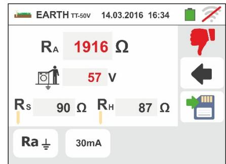
8. Para a **medição da resistência de terra nos sistemas IT**, nos casos de resultado negativo É apresentado, pelo instrumento, o ecrã mostrado ao lado em que aparece o valor da tensão de contacto no display secundário, o valor da resistência de contacto da sonda de tensão ( $R_s$ ) e o valor da resistência de contacto da sonda de corrente ( $R_h$ ).
