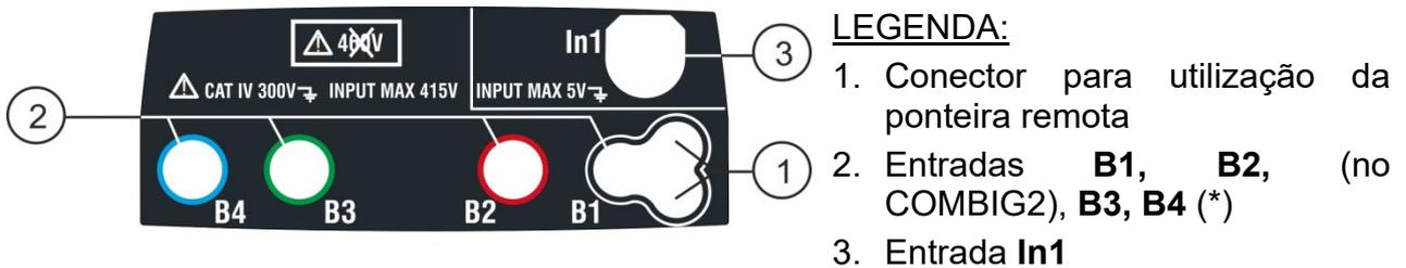
Fig. 2: Descrição da parte superior do instrumento
