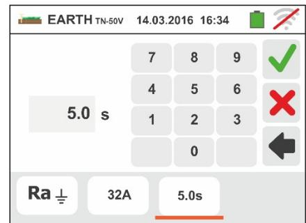
Com base nas selecções anteriores, o instrumento executa o cálculo do limite máximo da resistência de terra em função do valor da máxima tensão de contacto admitido que confrontará com o valor medido para fornecer o resultado final positivo ou negativo da medição.
