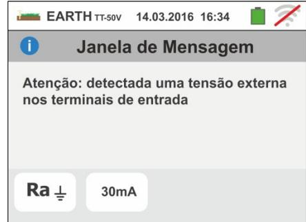
2. No início da medição, o instrumento verifica a continuidade dos cabos de medida. **Quando o circuito voltimétrico (cabos vermelho S e verde ES) está interrompido ou está presente uma resistência muito elevada**, o instrumento apresenta um ecrã semelhante ao mostrado ao lado.
