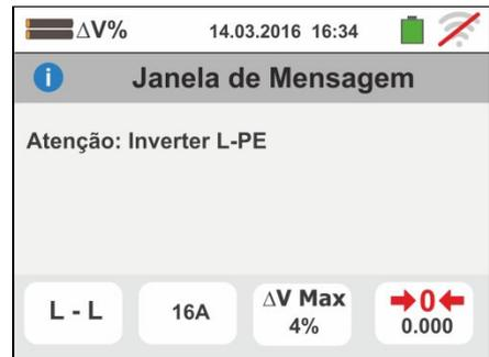
8. Quando é detetada a presença de uma tensão perigosa no terminal PE, o instrumento não efetua o teste e apresenta um ecrã como o mostrado ao lado. **Esta mensagem também pode ser apresentada devido a uma pressão insuficiente do botão GO/STOP**
