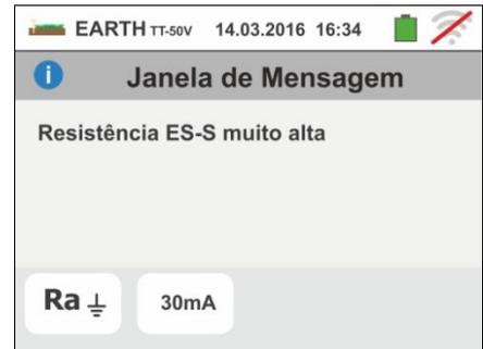
3. No início da medição, o instrumento verifica a continuidade dos cabos de medida. **Quando o circuito amperimétrico (cabos azul H e preto E) está interrompido ou está presente uma resistência muito elevada**, o instrumento apresenta um ecrã semelhante ao mostrado ao lado.
