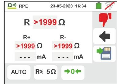
12. No final do teste **na função “Ω”**, se o valor medido da resistência for superior ao limite definido, o valor será mostrado em vermelho. A indicação ">1999Ω" indica a escala fora de escala do instrumento, como mostrado na tela ao lado
