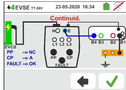
7. O teste RPE é realizado pelo instrumento **apenas no modo AUTO**. Defina o valor limite e execute a calibração dos cabos de medição conforme mostrado em § 6.1
