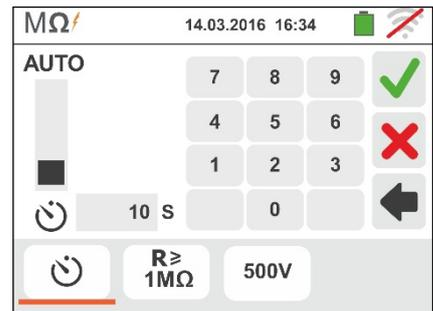
4. Tocar o ícone “R≥xxΩ” para configurar o valor limite mínimo da resistência de isolamento sobre o qual o instrumento executa a comparação com o valor medido. No display aparece o ecrã apresentado ao lado
