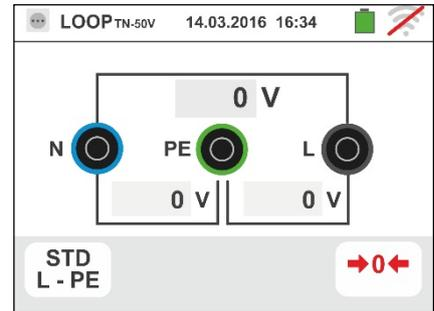
2. Mover a barra deslizante esquerda seleccionando o ícone para a execução da medição só com o instrumento ou o ícone para a execução da medição com instrumento + acessório opcional IMP57 (ver § 6.4.13). Mover a barra deslizante central seleccionando a opção “L-L, L-N ou L-PE”. Mover a barra deslizante direita seleccionando a opção “STD”. Confirmar a escolha voltando ao ecrã anterior.
