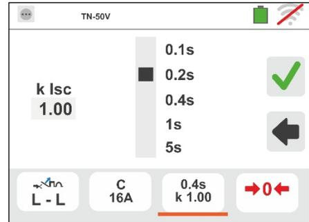
6. Tocor o ícone
