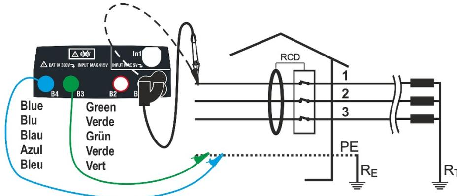
Fig. 16: Ligação em sistema trifásico 400V+ PE (não N) com cabos individuais e ponteira remota (não para RCD tipo B/B+)
