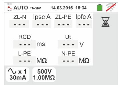
7. Premir o botão **GO/STOP durante alguns segundos** ou o botão **START** na ponteira remota para ativar o teste. Durante toda esta fase não desconectar os terminais de medida do instrumento da instalação em exame. No caso de seleção da **medição da corrente de disparo RCD** no display aparece o ecrã mostrado ao lado em que o ícone da ampulheta indica o desenrolar do teste
