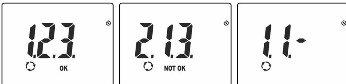
Fig. 16: Resultados positivos do teste da sequência e concordância das fases
