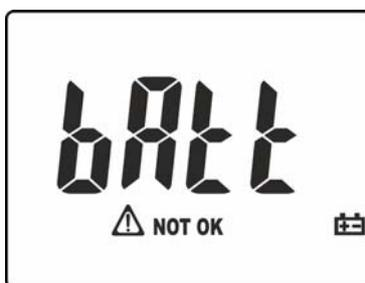
Fig. 45: Indicação de bateria descarregada
