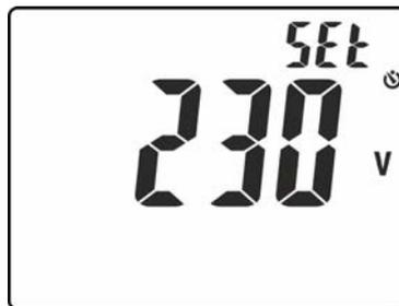
Fig. 6: Configuração da tensão nominal nas medições de Loop
