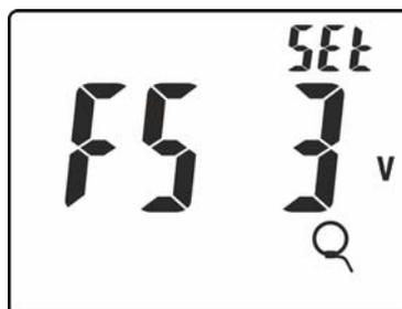
Fig. 7: Configuração fundo escala do transdutor com pinça flexível
