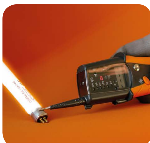
Test Lampade a GAS e continuità.
