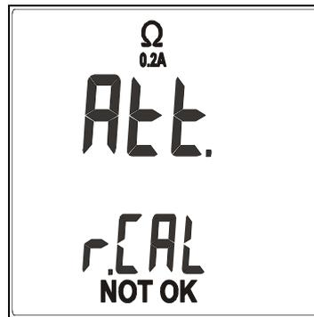
2. Si, au moment de la mesure, la tension se trouvant aux bornes est supérieure à 10V, l'instrument n'exécute pas l'essai. On émet un signal sonore prolongé pour indiquer la situation d'anomalie et on montre la page-écran ci-contre pendant 5 secondes ; ensuite, l'instrument affiche la page-écran par défaut relative à l'essai  $\Omega$  0.2A.
