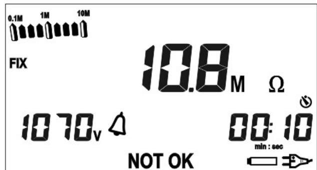
12. À la fin de la mesure, il est également possible d'afficher le courant de perte, le DAR (Rapport d'absorption diélectrique), le PI (Indice de Polarisation) et la capacité se présentant en séquence à la pression des touches fléchées (voir § 12.1)
