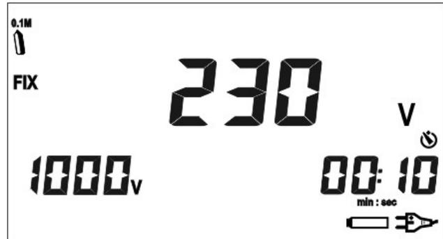
5. Appuyer sur la touche **MODE/CLEAR SMOOTH** pour régler l'une des tensions d'essai suivantes : 250V, 500V, 1000V, 2500V, 5000V.
