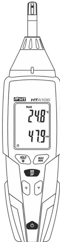
Fig. 3: Uso del instrumento para la medida de la temperatura/humedad del aire
