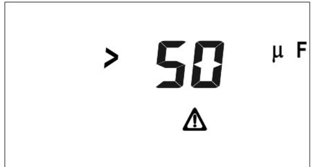
3. Si al presionar la tecla **START/STOP** (con  $1000V <$  tensión de prueba nominal configurada a  $\leq 2500V$  y la resistencia de carga es  $\geq 5M\Omega$ ) la capacidad de las puntas de prueba de entrada -Rx, +Rx es  $>$  a la capacidad límite admitida, será emitida una señal acústica prolongada y se visualizará la siguiente pantalla durante 3 segundos. Seguidamente el instrumento vuelve a la pantalla inicial.
