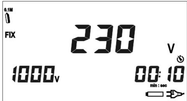
5. Pulse la tecla **MODE/CLEAR SMOOTH** para configurar una de las siguientes tensiones de prueba: 250V, 500V, 1000V, 2500V, 5000V.
