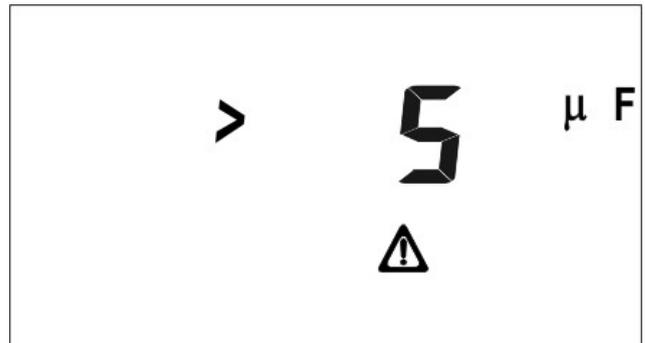
5. Si al presionar la tecla **START/STOP** o si durante una medición se detecta un nivel de la tensión de la batería de alimentación insuficiente, con tal de no perjudicar la prueba, la medición no se inicia o será interrumpida, luego emitirá una señal acústica prolongada y se visualizará la siguiente pantalla durante 3 segundos. Seguidamente el instrumento vuelve a la pantalla inicial.
